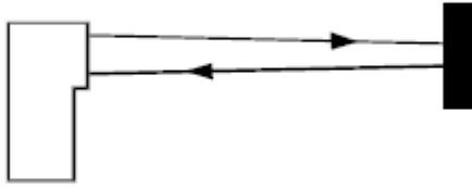
Ilustración 14: Funcionamiento por palpación directa
