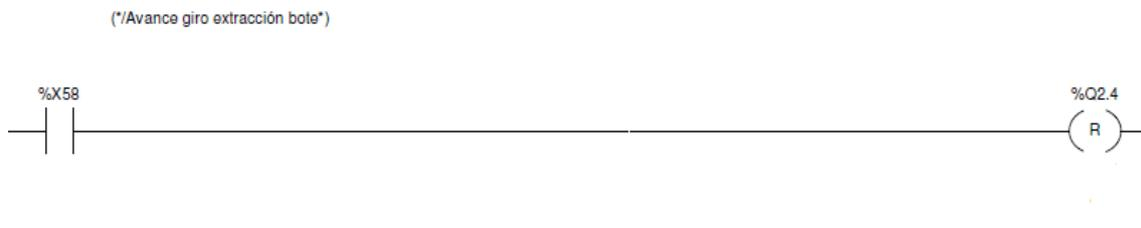
*Ilustración 69: Post, Avance giro extracción bote (Reset)*
