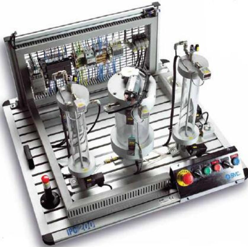
*Ilustración 2: Estación de producción (SMC International training, Manual de Usuario, Estaciones del proceso, pág. 8)*
