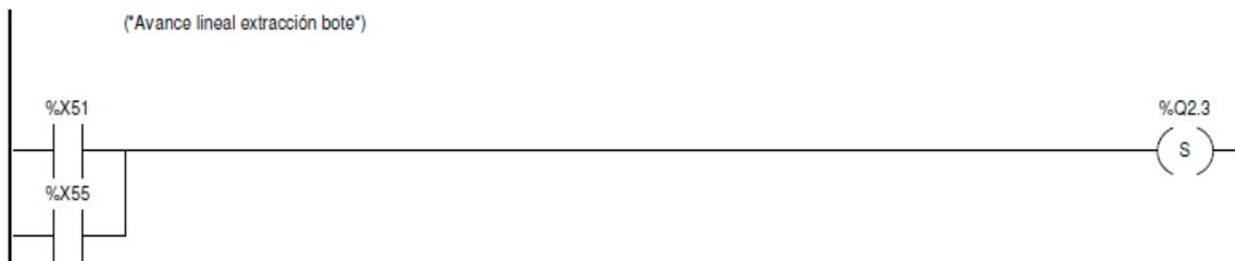
Ilustración 64: Post, Avance lineal extracción bote (Set)
