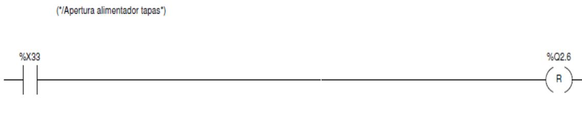
Ilustración 56: Post, Apertura alimentador tapas (Reset)
