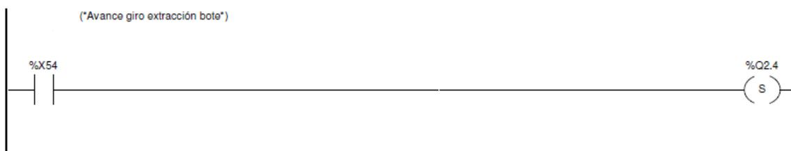
Ilustración 67: Post, Avance giro extracción bote (Set)
