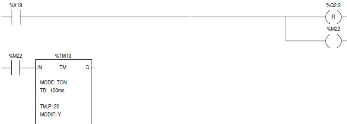
Ilustración 73: *Post*, Avance bloqueo y arrastre (Reset)
