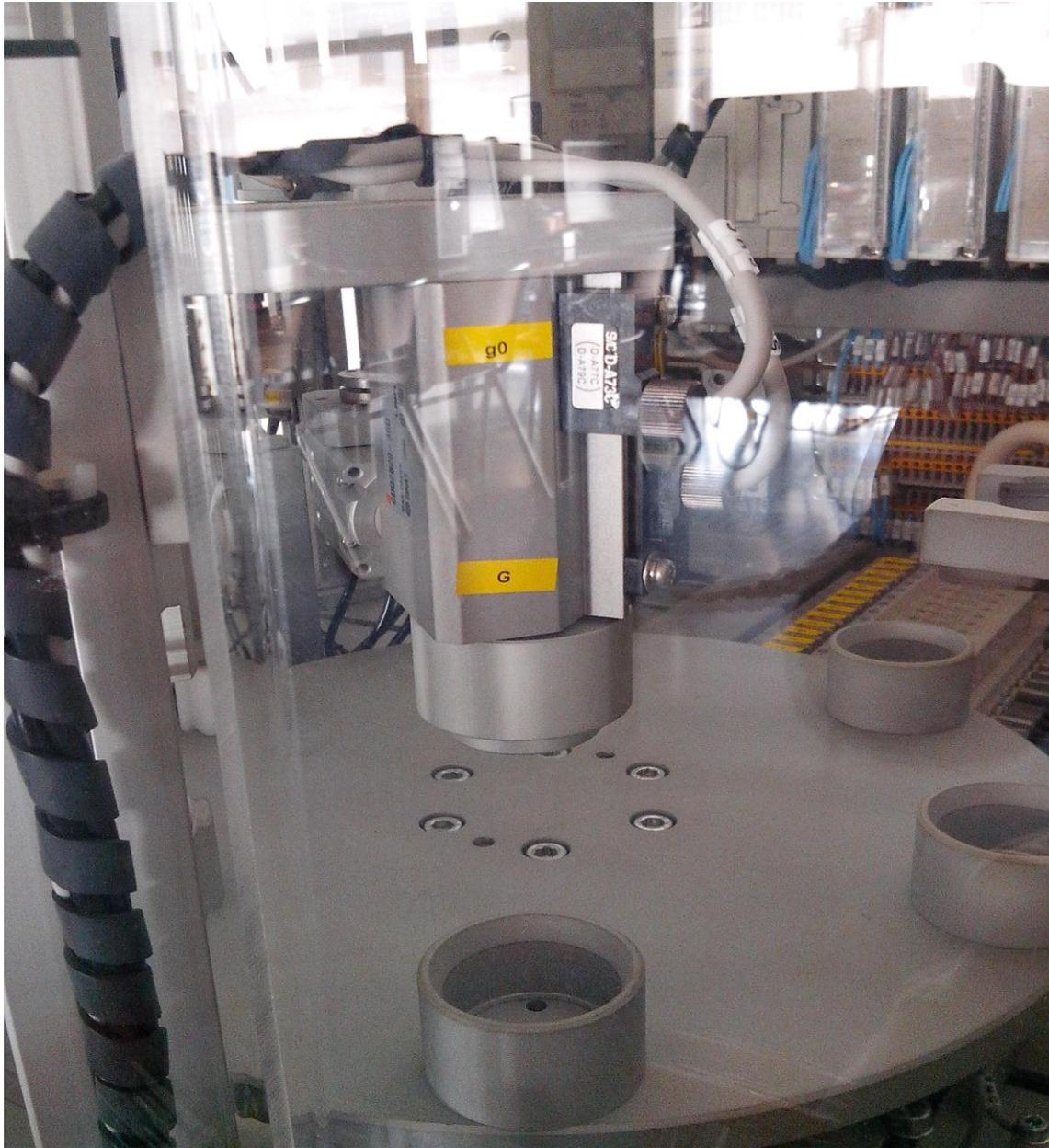
*Ilustración 28: Prensado de tapas*
