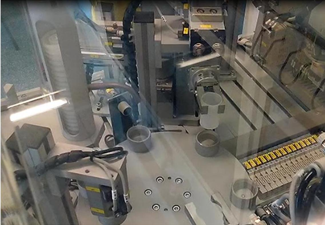
*Ilustración 25: Depósito de bote en mesa giratoria*
