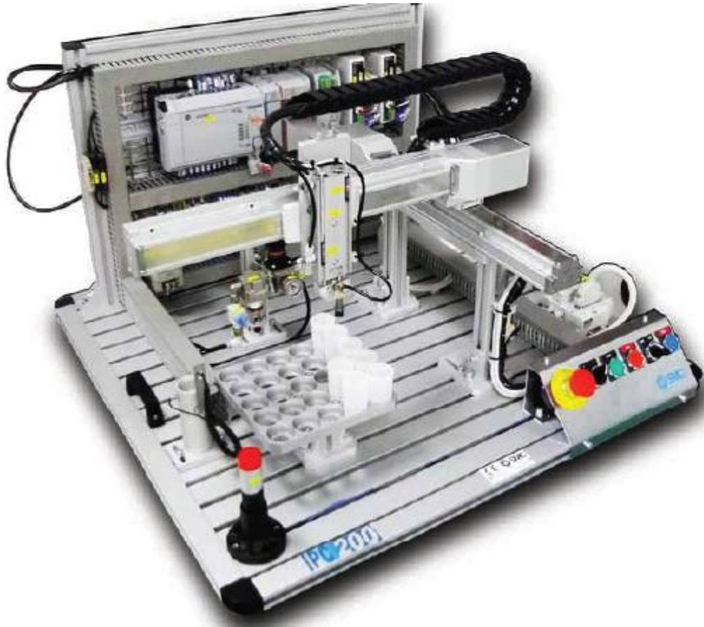
*Ilustración 4: Estación de paletizado (SMC International training , Manual de Usuario, Estaciones del proceso, pág. 23)*
