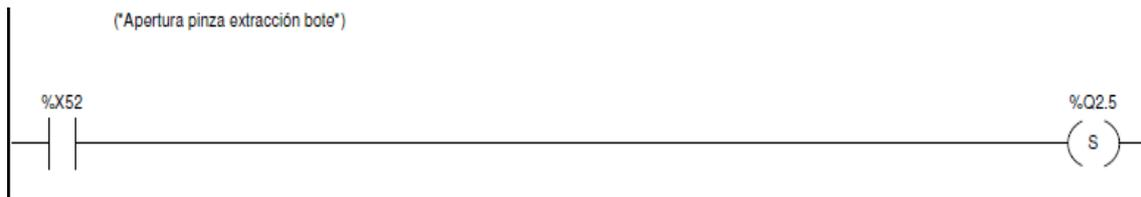
Ilustración 65: Post, Apertura pinza extracción bote (Set)
