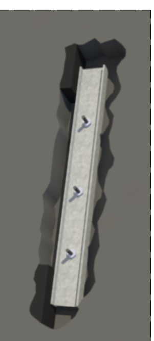
4. Colocación del perfil en los pasadores y apoyado sobre el mortero gROUT.
