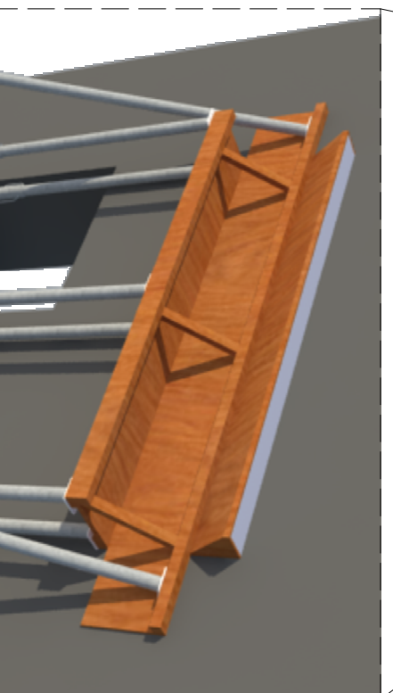
Detalle del encofrado.
