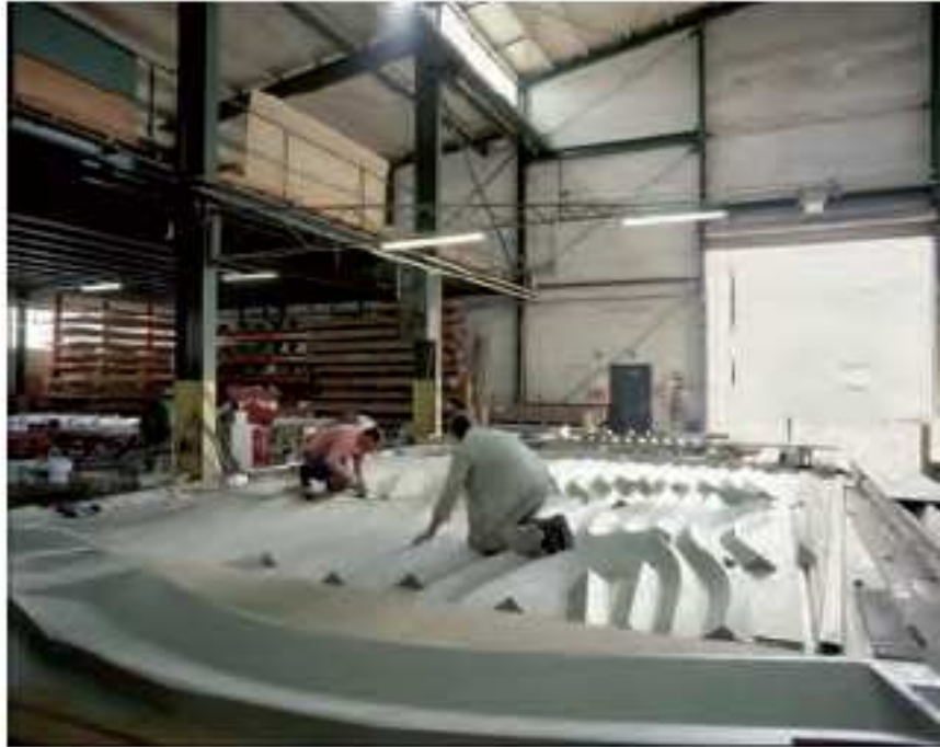
Imagen nº 37 Fabricación de la matriz Fuente: Catálogo RECKLI
