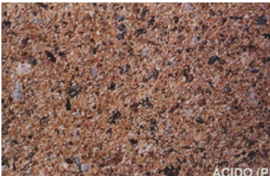
Imagen nº 29. Lavado al ácido. Exposición profunda Fuente:[10]
