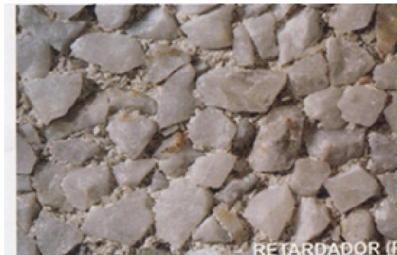
Imagen nº 18. Retardador y lavado. Exposición profunda Fuente: [10]
