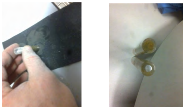
Fig. 6.1. Pulido del electrodo (izquierda) y superficies de un electrodo pulido y sin pulir.
