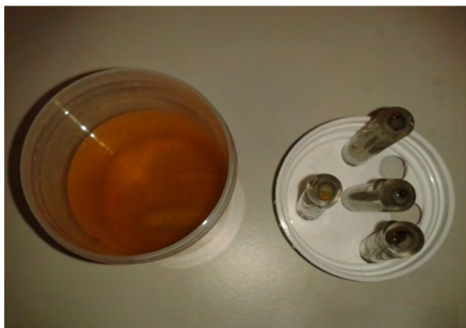
Fig. 6.17. Disolución y electrodos tras el ensayo de Voltametría Cíclica en disolución con Na_2SO_4 a pH11.
