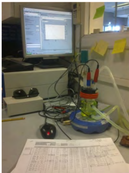
Fig. 6.1. Celda electroquímica. Configuración a 3 electrodos (WE-RE-CE).
