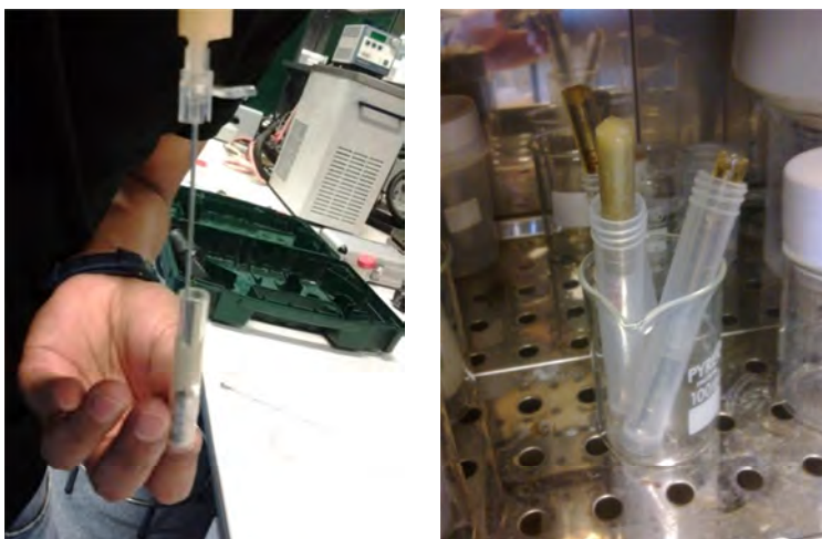
Fig. 6.7. Relleno interior con resina y curado en horno.
