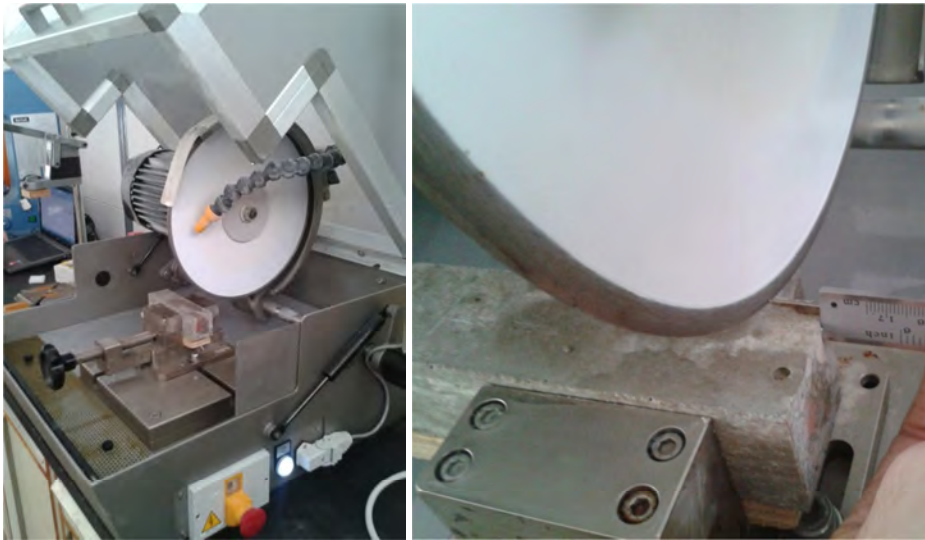
Fig. 5.12. Izquierda: Sierra circular para el corte de las probetas. Derecha: comprobación con pie de rey de las dimensiones de las piezas.
