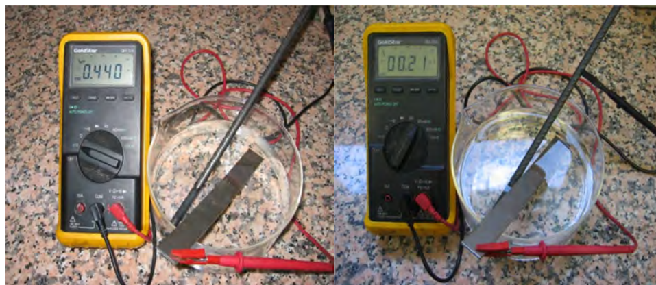
Fig. 2.23 Potencial entre una varilla de acero corrugado y una pletina de acero inoxidable: 440 mV (izquierda) y medida de la intensidad de corriente de la celda: 0.21 mA (derecha).
