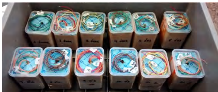
Fig. 4.6. Probetas fabricadas con diferentes concentraciones de cloruros añadidas al agua de amasado.
