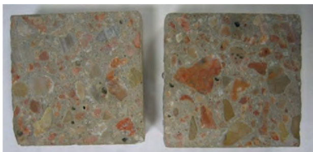
Fig. 5.30. Fotografía de dos piezas cortadas de la misma probeta donde se pueden apreciar las diferencias en la distribución de árido superficial.
