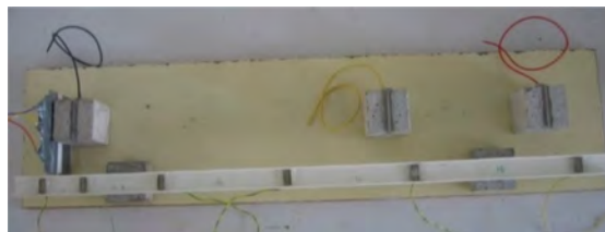
Fig. 5.42. Disposición de los sensores en la probeta
