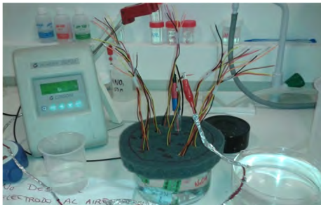
Fig. 3.12 Acondicionamiento de una serie de sensores. Medición realizada con pH-metro Crison
