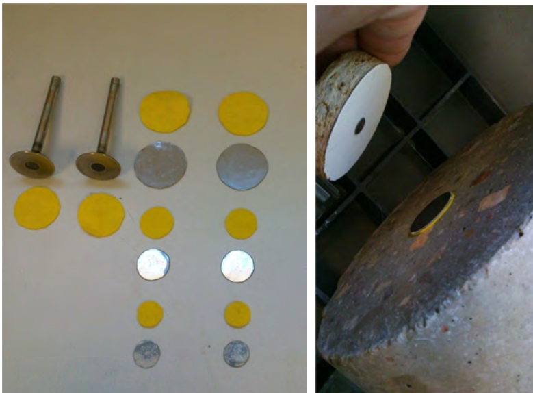
Fig. 5.46. Probeta cilíndrica con las bases para la presa (arriba) y electrodos empleados para realizar las medida (abajo).
