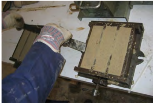
Fig. 5.10. Fabricación de probetas de 16x4x4 cm
