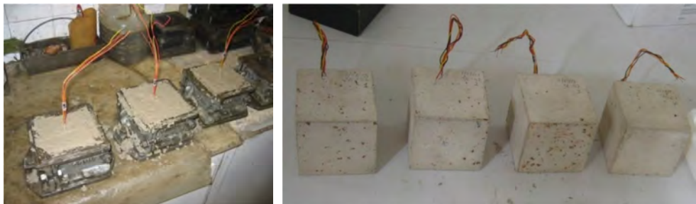
Fig. 3.14 Fabricación de probetas de hormigón con los sensores embebidos.
