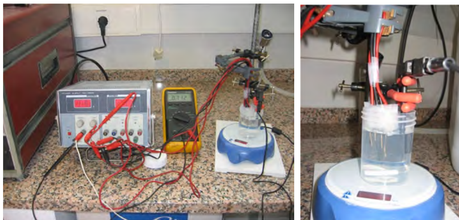
Fig. 2.6 Anodizado de alambres para ser utilizados como sensores de Ag/AgCl.
