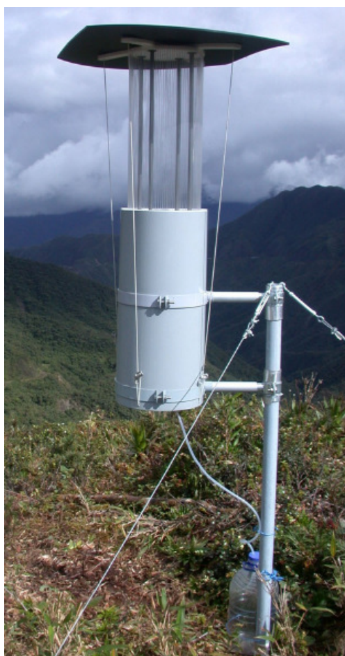
Figura 2-5: Colector cilíndrico tipo arpa, con hilos de teflón como material de recolección (Beiderwieden et al., 2005)
