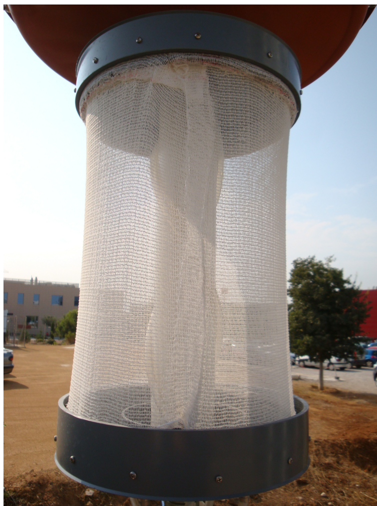
Figura 3-3: Colector de niebla cilíndrico de tipo malla, elaborado con malla tipo raschel como material de recolección
