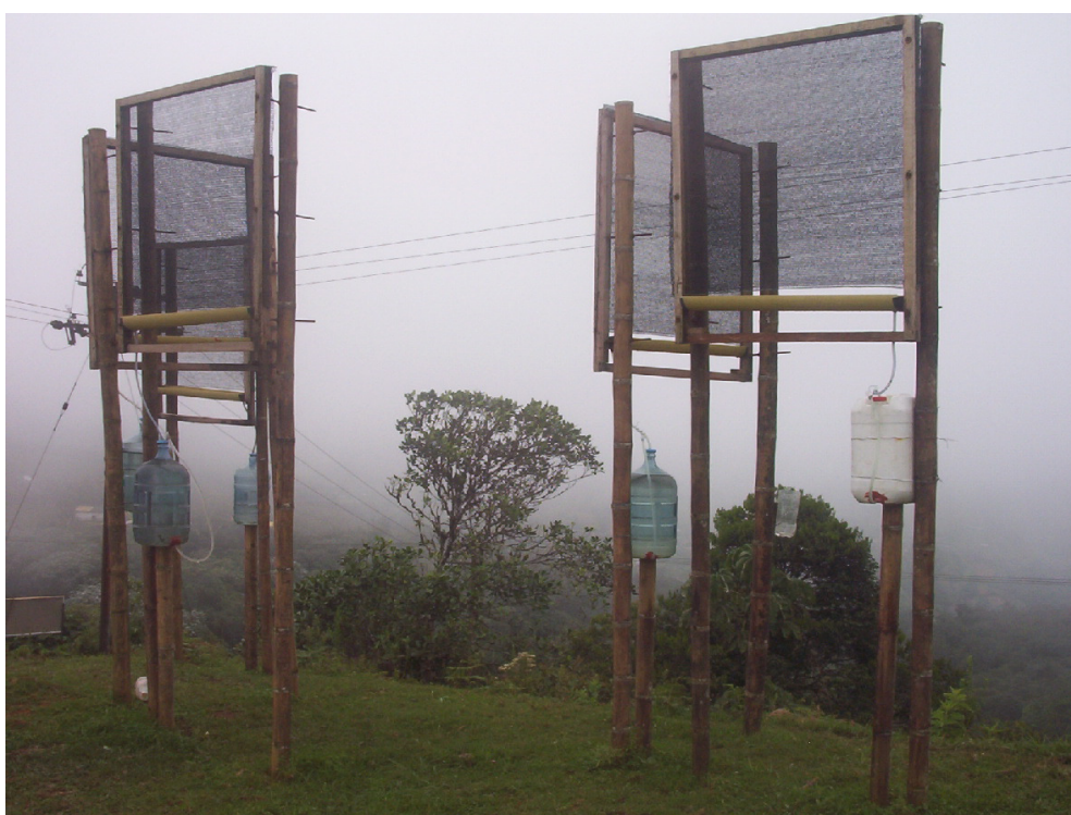
Figura 2-12: Doble pareja de SFC instalada en el valle de Roldanillo (Colombia). Cada pareja de colectores forma un ángulo de 90^\circ entre ellos, para evaluar distintas orientaciones de recogida de niebla (imagen cedida por José Manuel Molina (Universidad del Estado de Colorado-USA))
