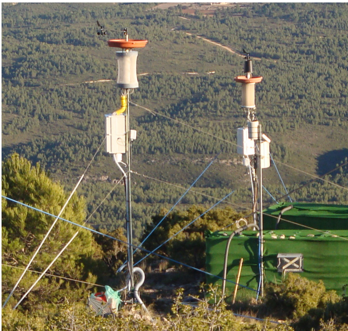
Figura 3-9: Disposición en campo de los dos colectores cilíndricos experimentales comparados, situados en Machos (Ayora, Valencia). A la izquierda, el colector de tipo malla y a la derecha, el de tipo arpa
