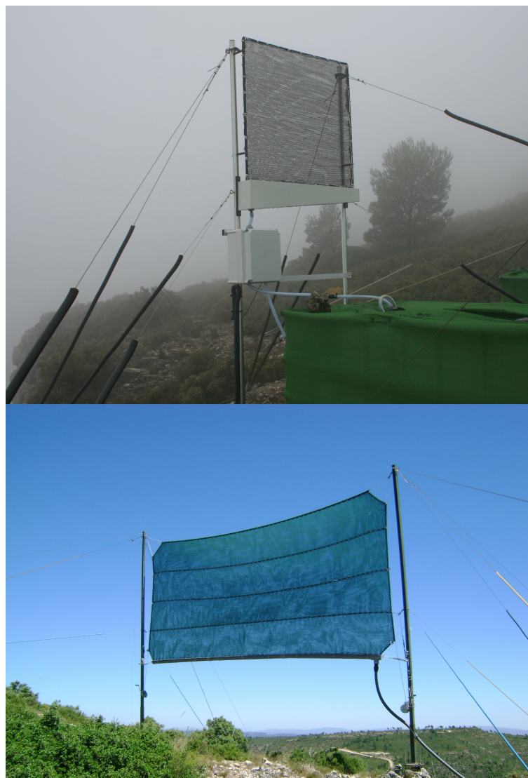
Figura 2-2: Standard Fog Collector, de 1 m 2 (1 x 1 m) de superficie de captación (parte superior); Large Fog Collector de 18 m 2 (6 x 3 m) de superficie de captación (parte inferior); ambos instalados en Ayora (Valencia)
