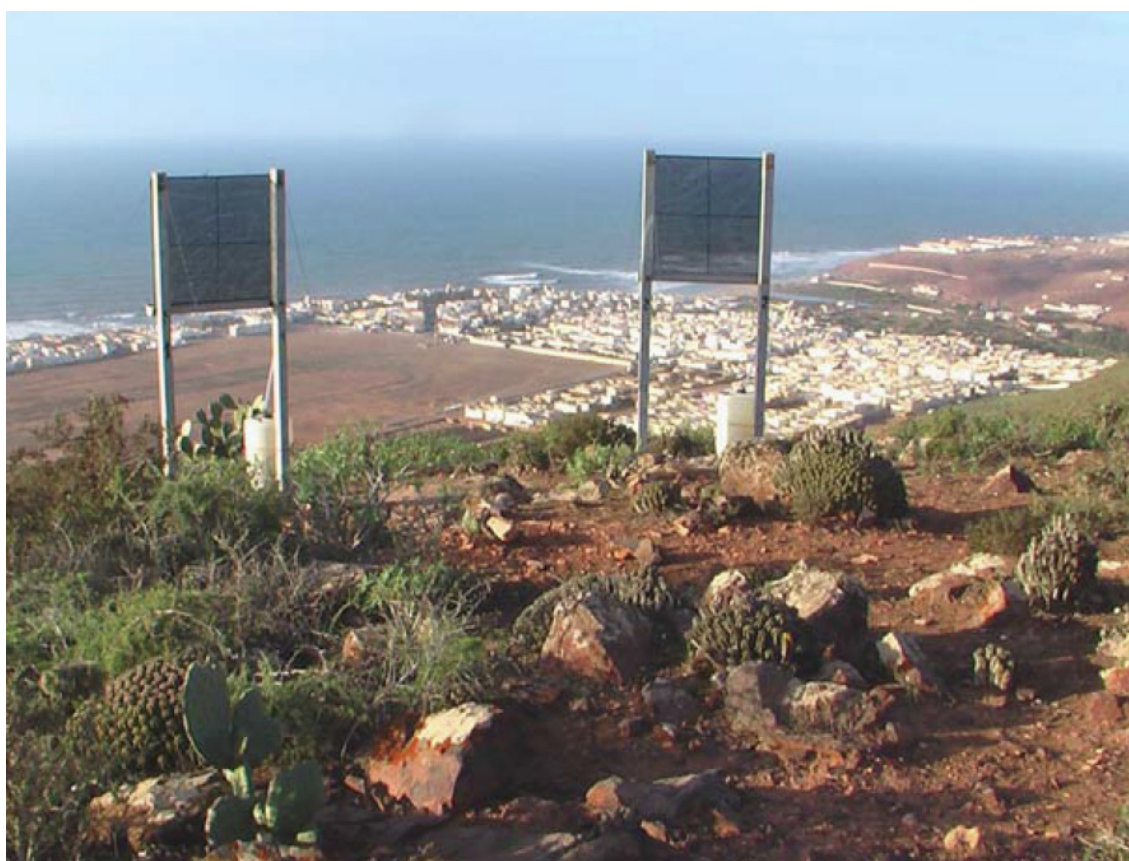
Figura 2-9: Pareja de captadores instalada en Boulaalam (Marruecos), a 300 m sobre el nivel del mar, orientados a WNW (izquierda) y NNW (derecha). A los pies, la ciudad de Ifni y el océano Atlántico (Marzol and Sánchez-Megía, 2008b)
