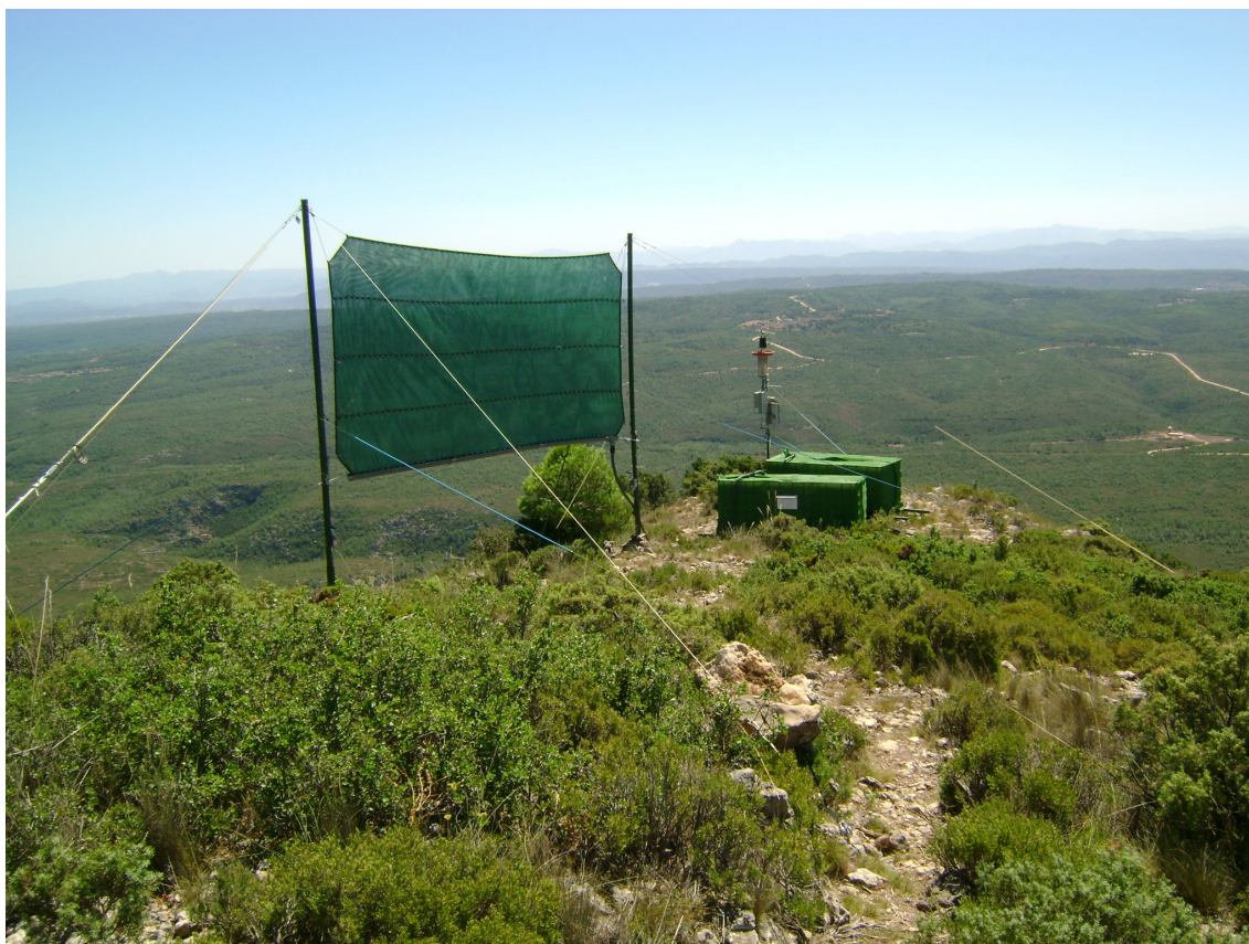
Figura 3-13: Disposición en campo del colector industrial plano de tipo LFC (izquierda) y el colector cilíndrico experimental de tipo arpa (derecha, situado detrás de los depósitos de almacenamiento), instalados en Machos (Ayora, Valencia)
