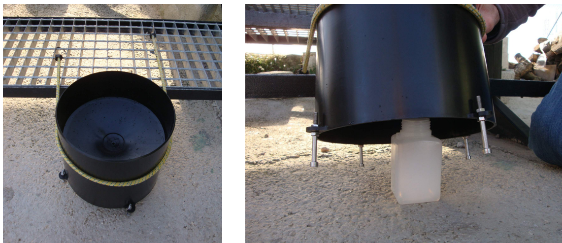
Figura 6-3: A la izquierda, dispositivo utilizado para la recolección de las muestras de lluvia pura; a la derecha, detalle de la botella de polietileno localizada en el interior de la carcasa encargada del almacenamiento de la muestra
