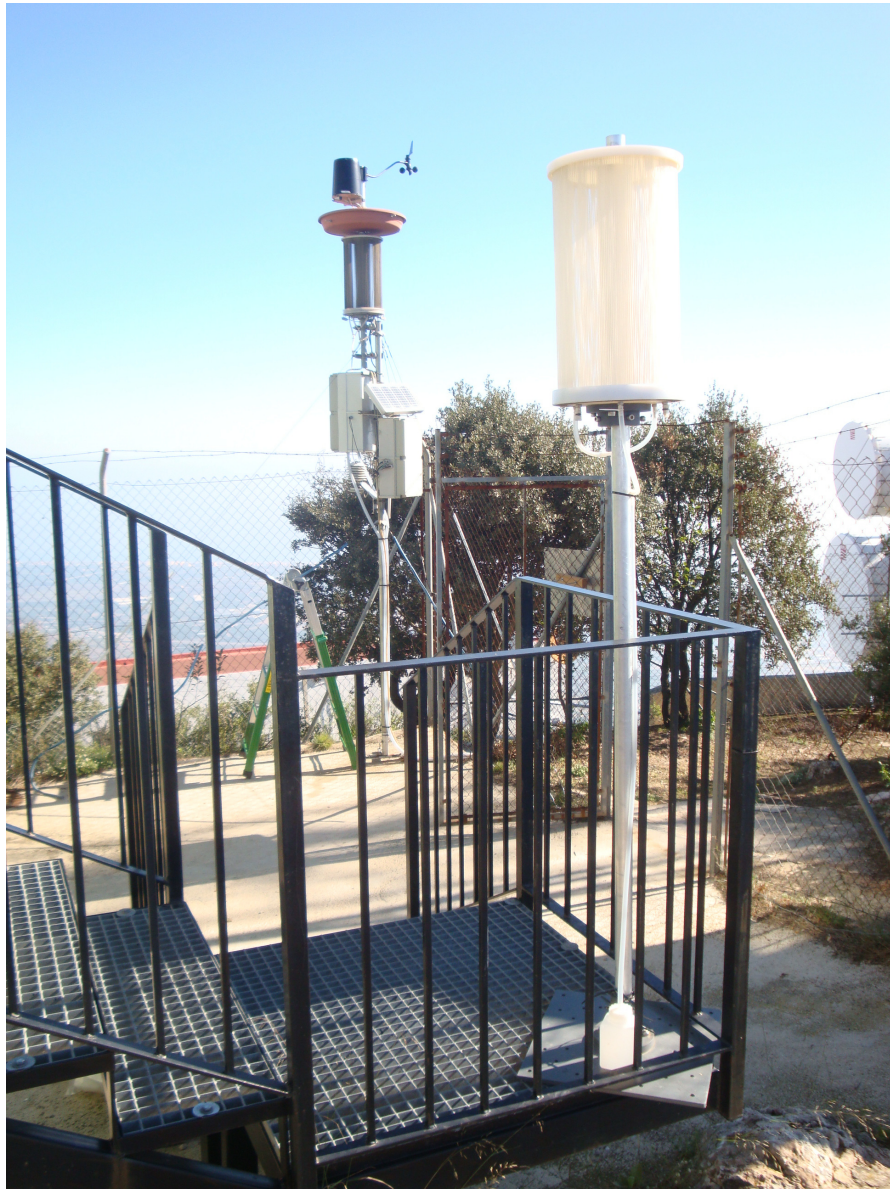
Figura 6-2: En primer plano, colector de niebla pura, y en segundo plano, colector de niebla con deposición atmosférica. Nótese la diferencia de color entre ambos colectores debido a la contaminación sufrida por el segundo tras el paso del tiempo
