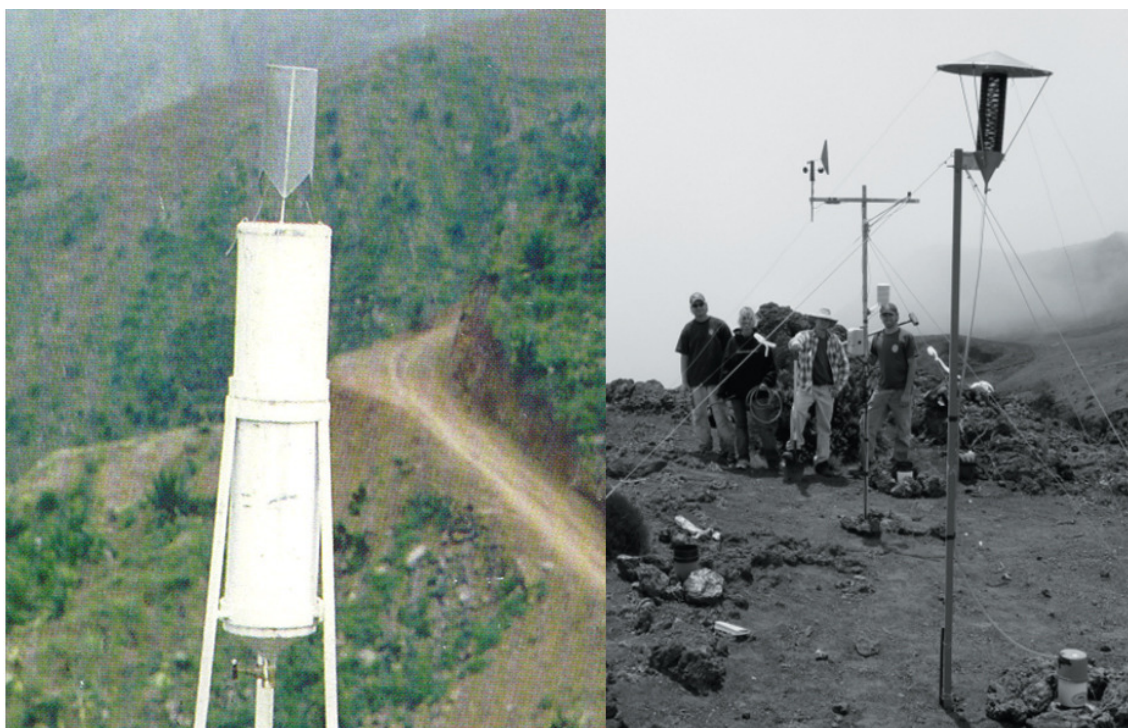
Figura 2-4: Colector tipo Grunow (izquierda), el cual presenta un pluviómetro tipo Hellmann como depósito y medidor del agua capturada (Acosta-Baladón, 1996); colector tipo Juvik (derecha), con protector superior para la lluvia en su parte superior y con un pluviómetro automático situado en el suelo y unido a éste por una manguera, para cuantificar el agua recogida (Juvik et al., 2005)
