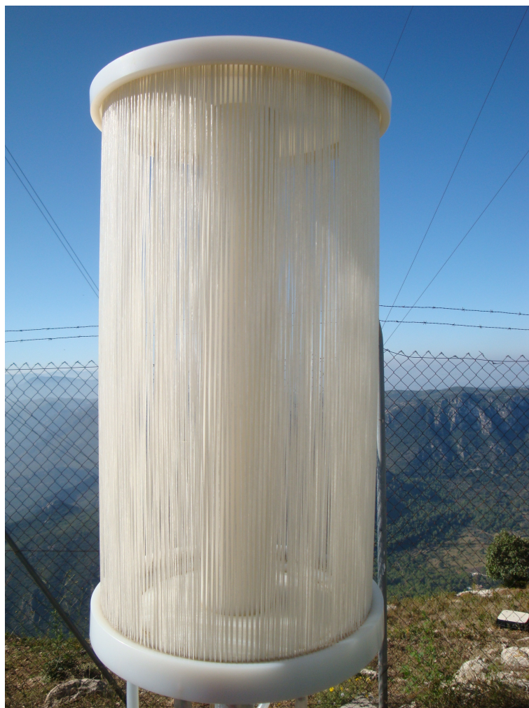
Figura 3-2: Colector de niebla cilíndrico de tipo arpa, elaborado con hilo de nylon como material de recolección
