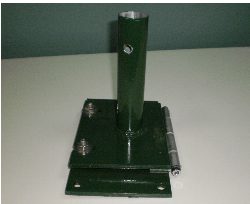
Figura 3-5: Base abatible utilizada para sujetar el mástil que da enganche a todo el sistema de prospección de agua de niebla. La base cuenta con una bisagra que permite llevar el equipo a nivel del suelo
