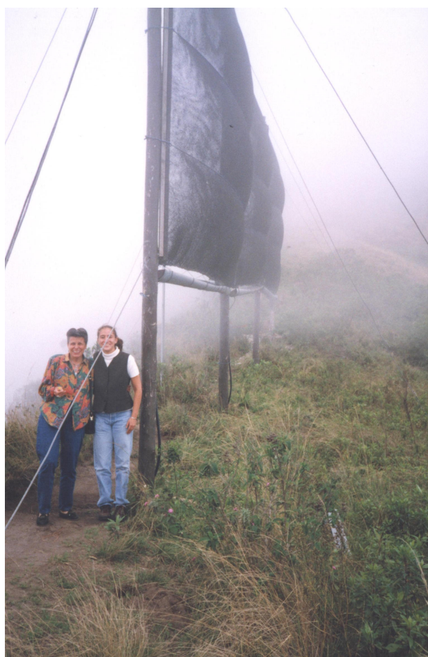
Figura 2-14: Colector LFC captando niebla en El Cráter (Ecuador) (imágenes cedidas por Roberto Román L. (Universidad de Chile))
