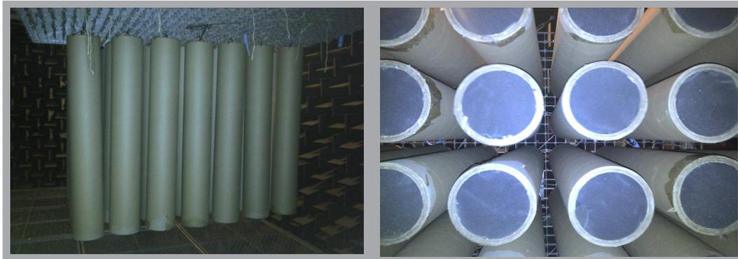
Figura 3.7: Cilindros rígidos de cartón prensado de 1.20 m de altura. De izquierda a derecha: estructura completa formada por 28 dispersores y vista del ordenamiento utilizado: red cuadrada.
