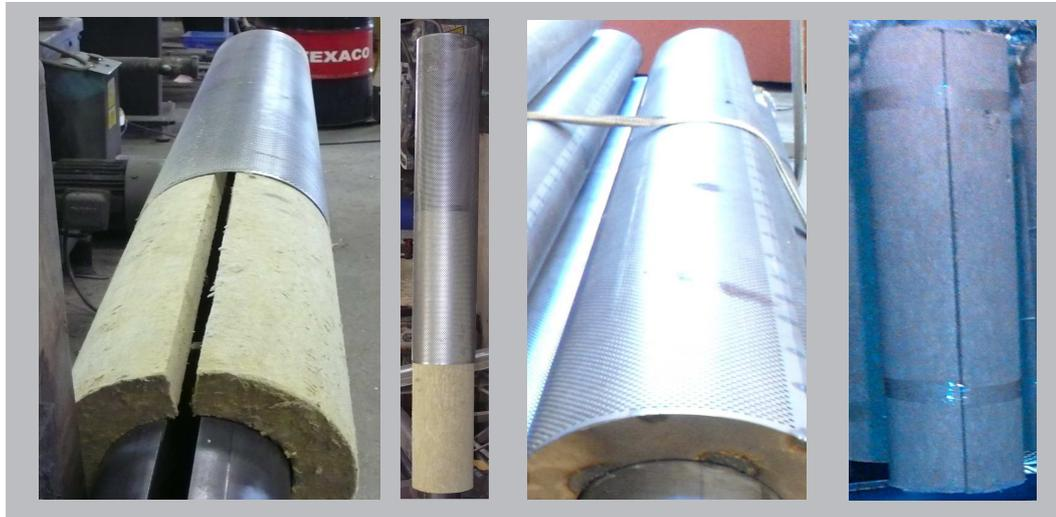
Figura 3.8: Cilindros rígidos con cavidad resonante y recubiertos de material absorbente (lana de roca). De izquierda a derecha: detalle de las partes del dispersor, de la chapa perforada cilíndrica utilizada para dar consistencia y proteger al dispersor, de los dispersores multifenómeno listos para ser utilizados y de un dispersor multifenómeno sin chapa perforada.
