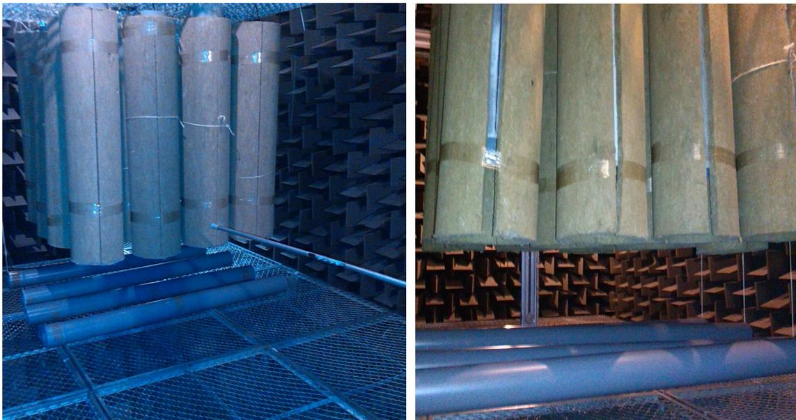
Figura 7.26: Montaje experimental del análisis de la difracción en el borde con satélites: ambas imágenes muestran la estructura analizada, formada por 16 dispersores multifenómeno y los satélites situados en el segundo borde de cada fila de dispersores situados a una altura de un paso de red.
