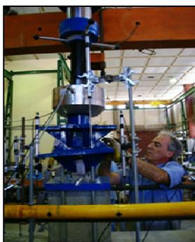
**Figura 4.35** Ajuste del actuador hidráulico de la fuerza vertical al soporte de ensayo.
