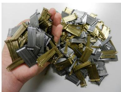
**Figura 2.1** Fibras metálicas.
