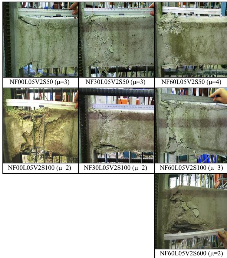
**Figura 5.1** Análisis del contenido de fibras y del nivel de confinamiento en soportes de hormigón convencional (Serie 1).
