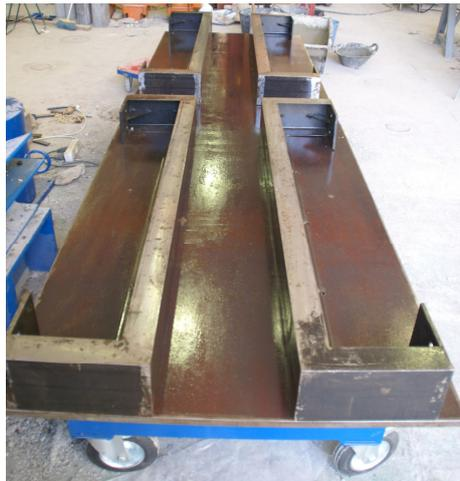
**Figura 4.14** Mesa del encofrado utilizado para la fabricación de los soportes.
