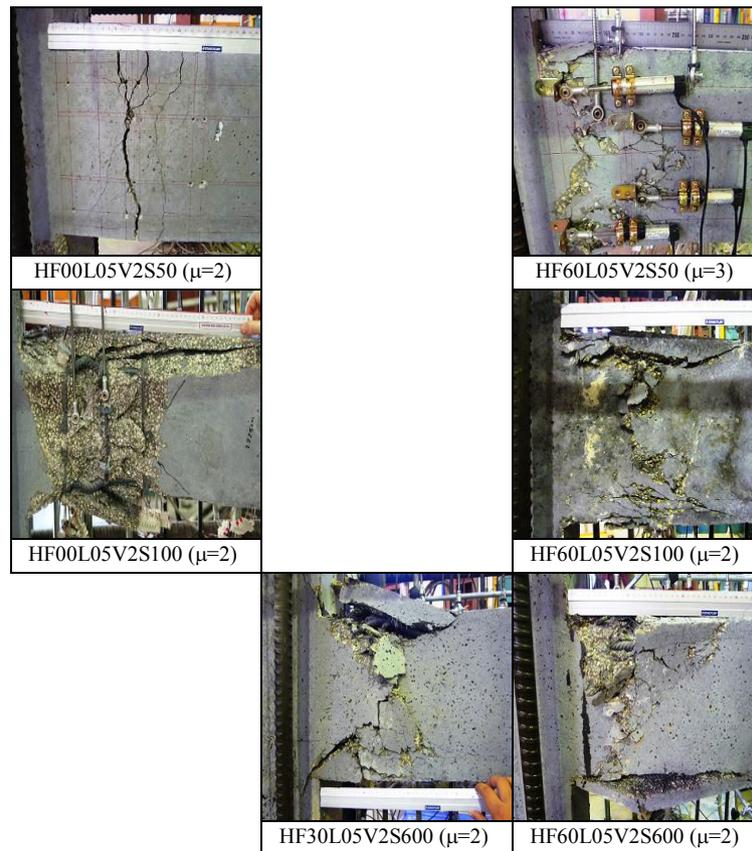
**Figura 5.2** Análisis del contenido de fibras y del nivel de confinamiento en soportes de alta resistencia (Serie 2).
