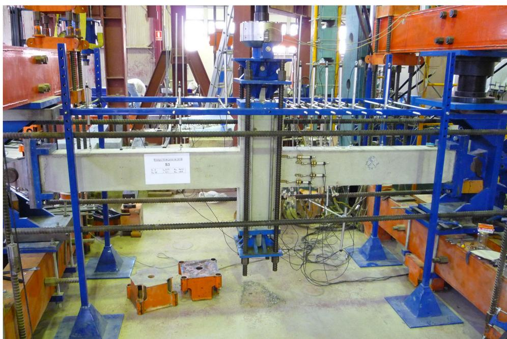
**Figura 4.27** Soporte posicionado en el pórtico de ensayo con toda la instrumentación conectada.
