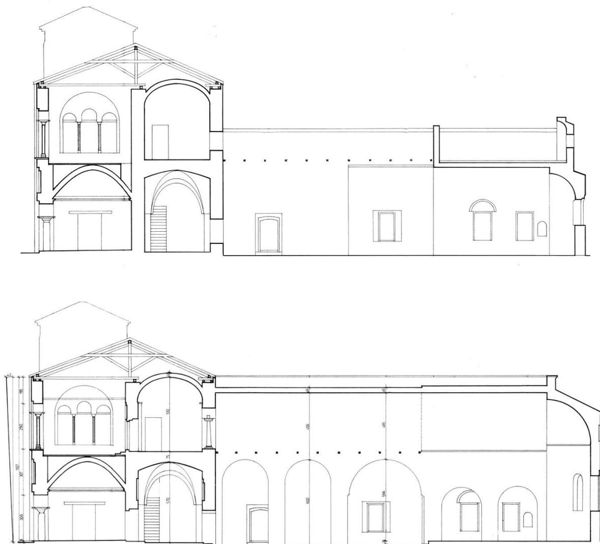
Fig. IV-33: Secciones longitudinales de la iglesia de Santa Sofía. Estado actual. A: sección de la nave lateral (norte) y B: sección de la nave central.
