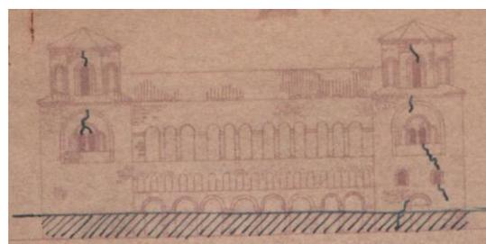
Fig. V-04: Esquema de los daños principales (la nave sur del naos y el exonártex, con las fachadas correspondientes) de la iglesia de Santa Sofía en Ohrid.
