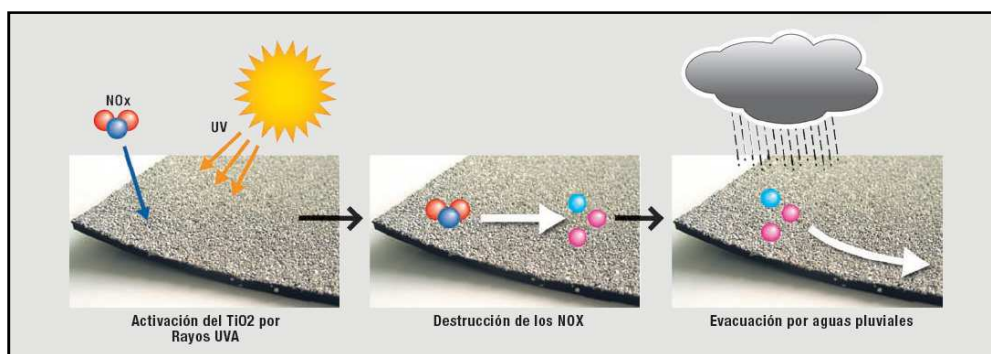
Figura 282: Lámina protegida por material descontaminante \text{TiO}_2 .
