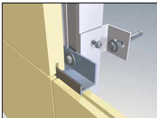
Figura 233: (1) Vivienda unifamiliar prefabricada. (2) Detalle de anclaje atornillado
