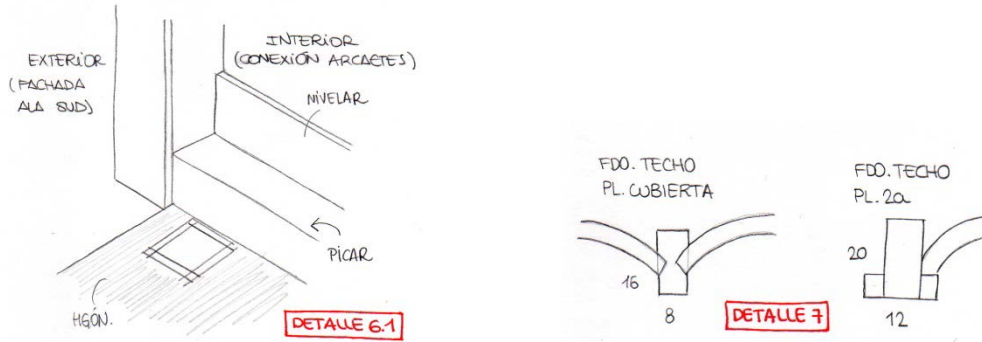
Detalle 6. Croquis sobre cómo resolver los encuentros con los muros en la planta baja Ala Sud – “les Arcaetes”. Detalle 7. Secciones de los dos tipos de forjado que presenta el Ala Sud.
