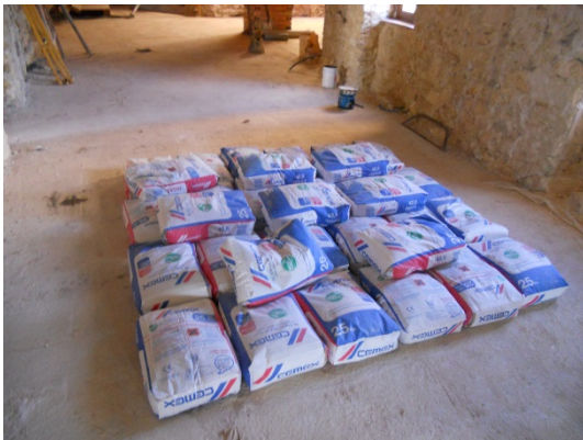
Imagen 3-Observaciones. Prueba de carga realizada mediante sacos de cemento de 25 Kg.
