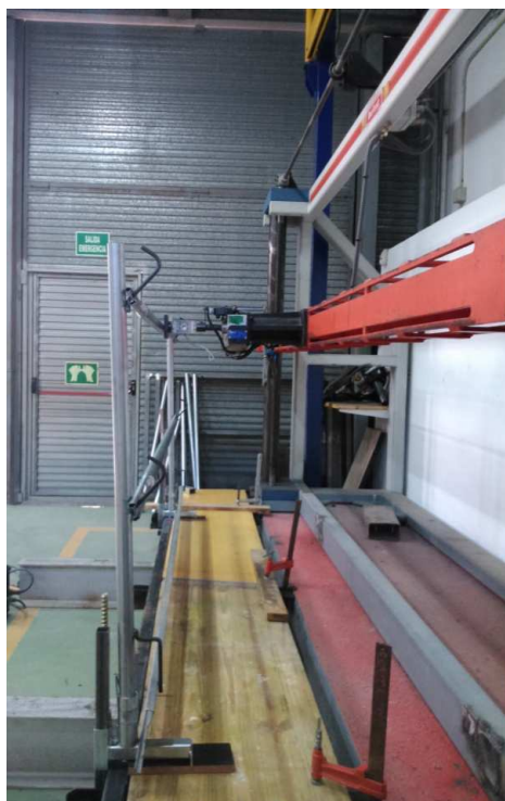
Fotografía 48. Ensayo de límite elástico barandilla principal muestra 1 UNE-EN 13374:2013
