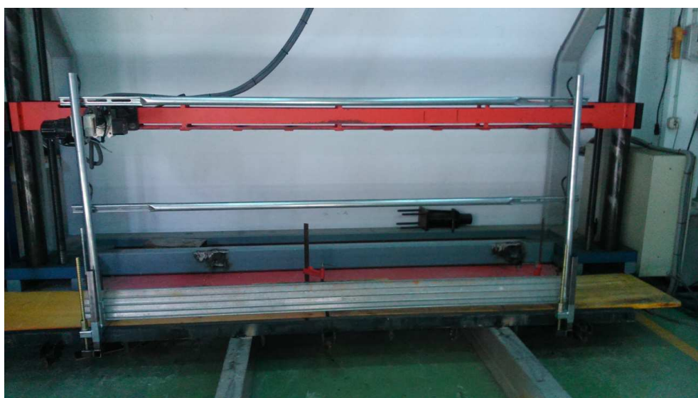
Fotografía 47. Fotografía del Sistema provisional de protección de borde
