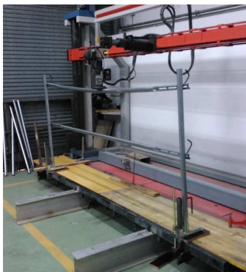
Fotografía 42. Aplicación de la carga accidental
