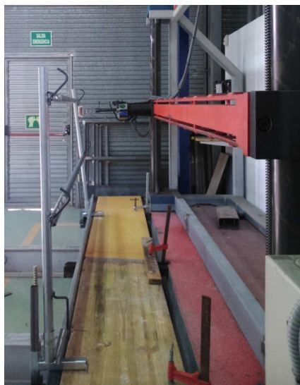
Fotografía 56. Ensayo de resistencia última poste muestra 1 UNE-EN 13374:2013
