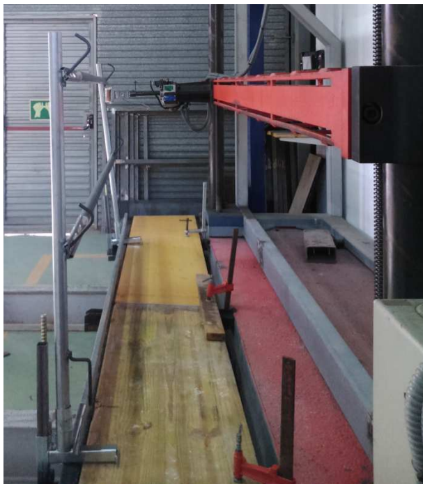
Fotografía 63. Ensayo de resistencia poste muestra 1 OSHA 1926.502
