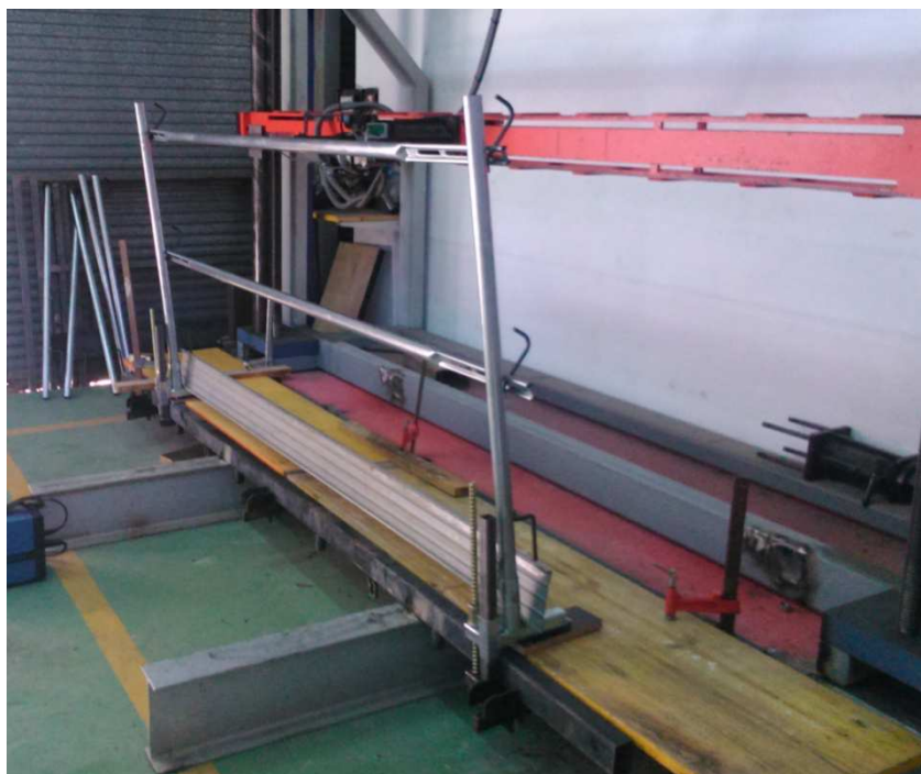
Fotografía 50. Ensayo de resistencia última barandilla ppal muestra 1 UNE-EN 13374:2013
