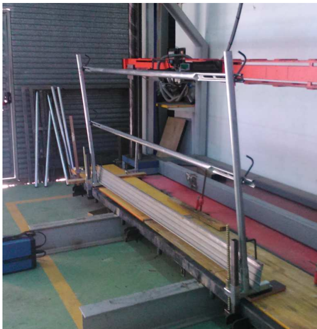
Fotografía 59. Ensayo de resistencia barandilla principal muestra 1 OSHA 1926.502
