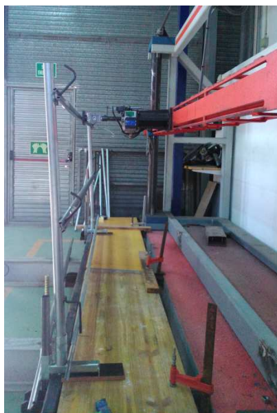
Fotografía 37. Ensayo de límite elástico, aplicando la carga en el centro de la barandilla.
