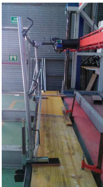
Fotografía 39. Aplicación de la carga en la barandilla superior UNE EN 13374:2013
