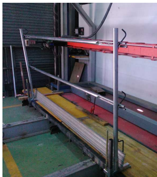
Fotografía 38. Ensayo de límite elástico, aplicando la carga en lo alto del poste.
