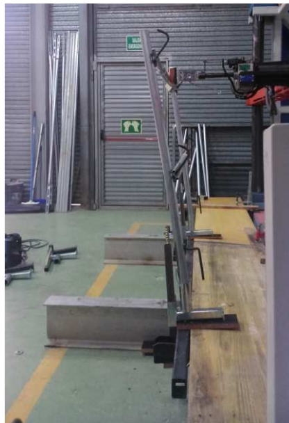
Fotografía 64. Ensayo de resistencia barandilla superior muestra 1 RTP-01
