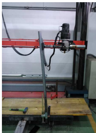
Fotografía 41. Aplicación de la carga paralela
