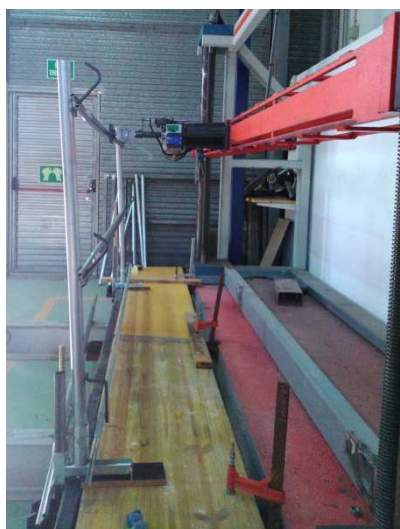
Fotografía 43. Aplicación de la carga en la barandilla superior OSHA 1926.502
