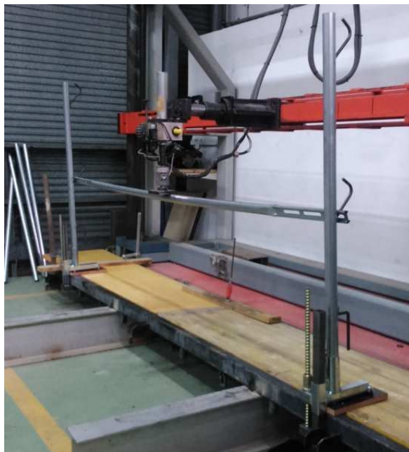
Fotografía 61. Ensayo de resistencia carga vertical b. intermedia muestra 1 OSHA 1926.502
