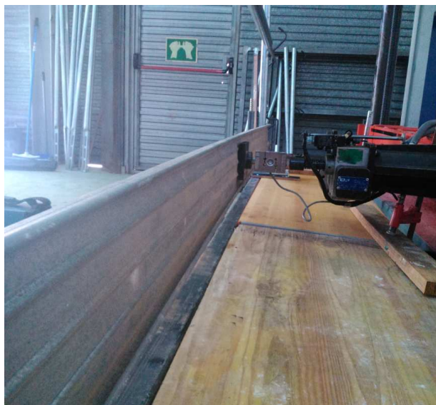
Fotografía 52. Ensayo de resistencia rodapié muestra 1 UNE-EN 13374:2013
