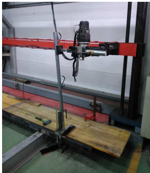
Fotografía 58. Ensayo de límite elástico barandilla principal muestra 1 UNE-EN 13374:2013
