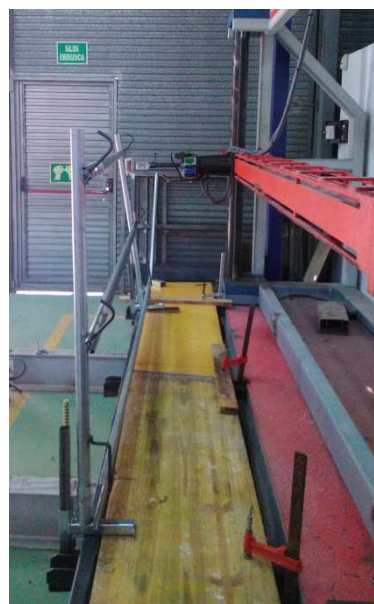
Fotografía 40. Aplicación de la carga en el poste UNE EN 13374:2013
