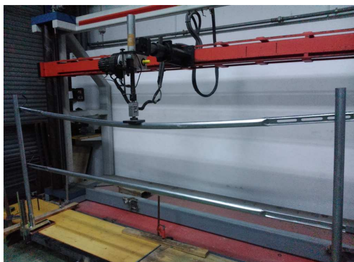
Fotografía 60. Ensayo de resistencia carga vertical barandilla ppal muestra 1 OSHA 1926.502
