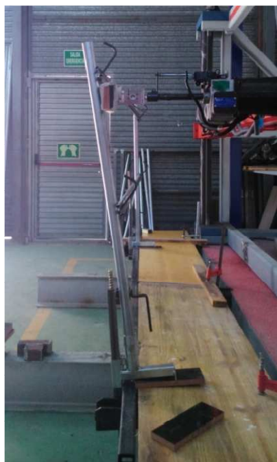
Fotografía 65. Ensayo de resistencia poste muestra 1 RTP-01
