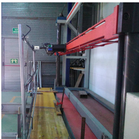
Fotografía 49. Ensayo de resistencia barandilla principal muestra 1 UNE-EN 13374:2013
