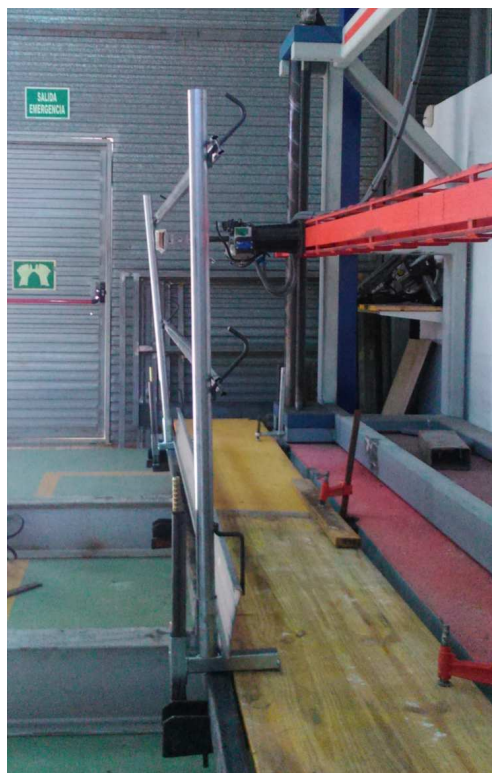
Fotografía 55. Ensayo de resistencia poste muestra 1 UNE-EN 13374:2013
