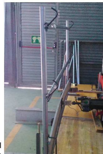
Fotografía 45. Aplicación de la carga en el rodapié OSHA 1926.502
