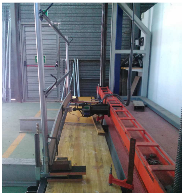
Fotografía 53. Ensayo de resistencia última rodapié muestra 1 UNE-EN 13374:2013
