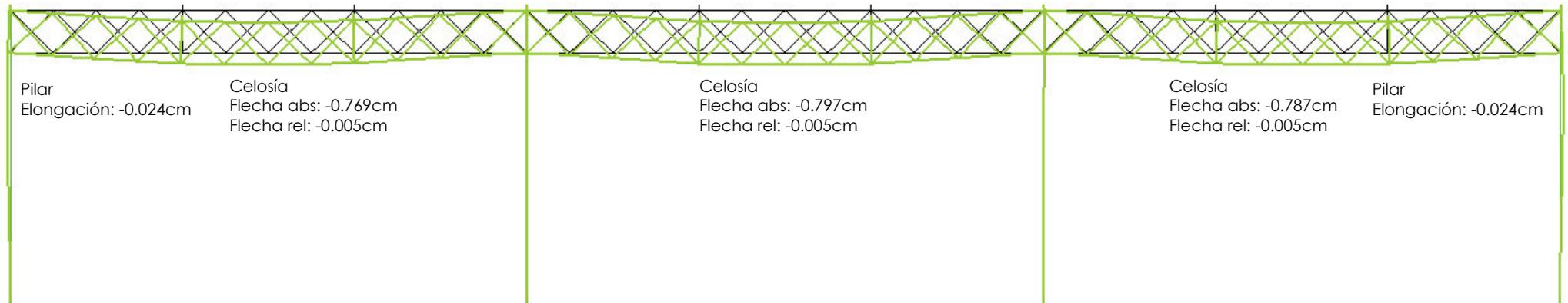
Fig. 71. Deformada del eje C. Combinación Característica 2. ELS
