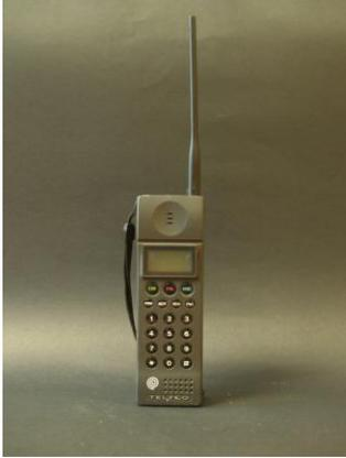
FIGURA 11. Teléfono fijo Inalámbrico
