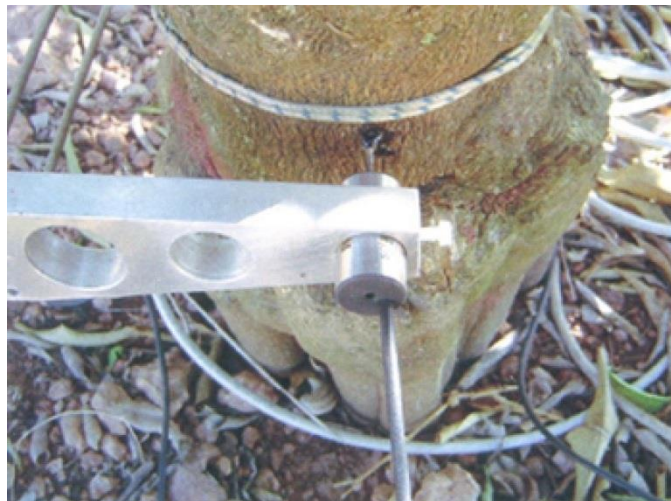
Ilustración 2: Dendrómetro instalado en el tronco de un naranjo (IVIA)
