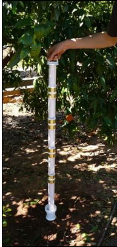
Ilustración 1: Sonda capacitiva FDR con sensores a diferentes niveles de profundidad
