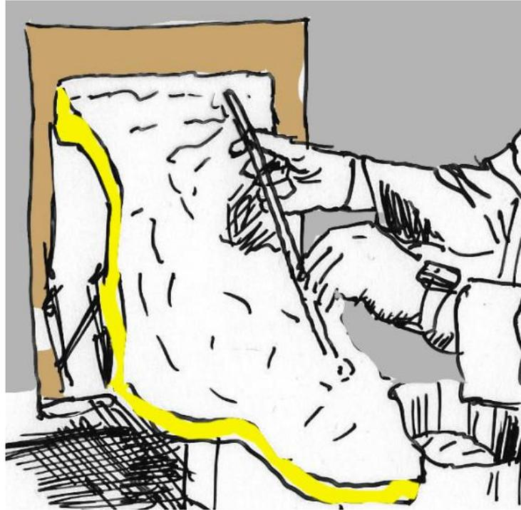
Figura 7. Refuerzo con varilla de fibra de vidrio del contramolde
