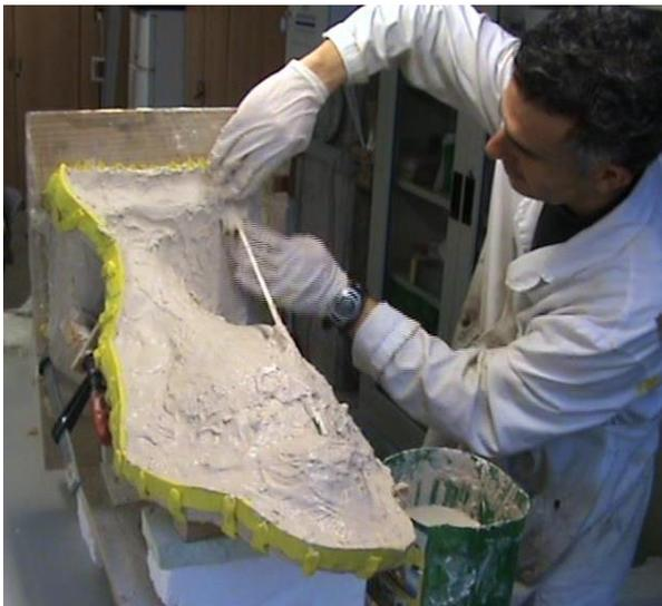
Figura 20. Aplicación de varillas de vidrio al contramolde
