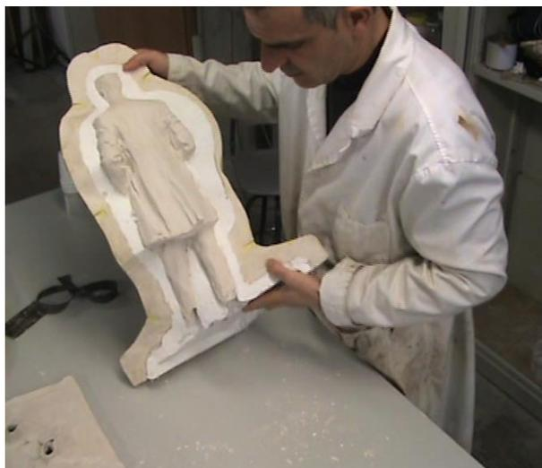
Figura 23. Extracción copia de prueba
