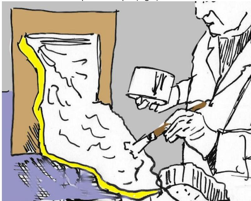
Figura 6. Realización del contramolde. Aplicación con brocha
