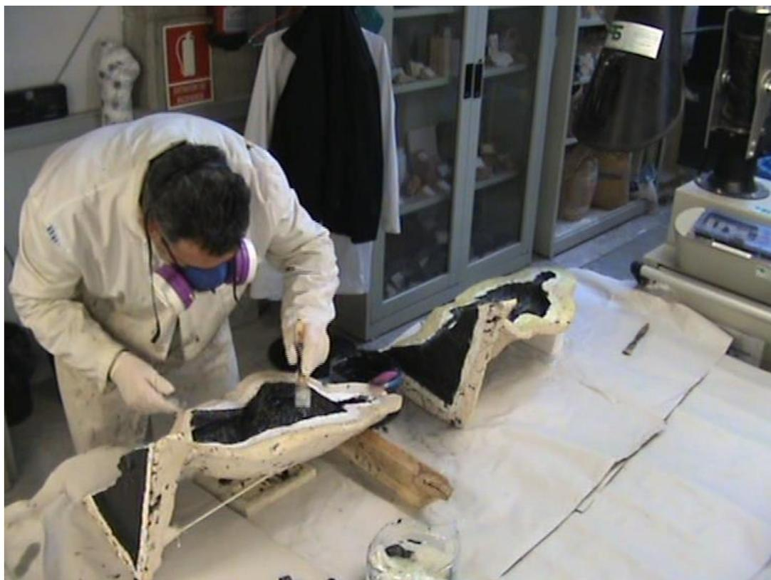
Figura 24. Elaboración de la copia en resina de poliéster con fibra de vidrio en dos mitades huecas.
