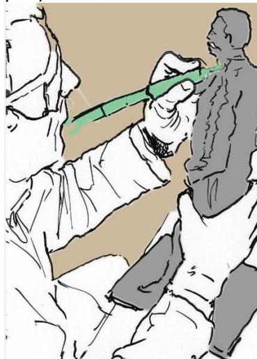
Figura 16. Eliminación de rebabas con Micromotor
