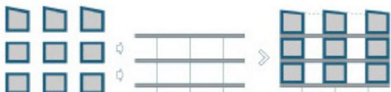
Fig. 55. Esquema de utilización de los módulos prefabricados para estructuras residenciales obsoletas.
