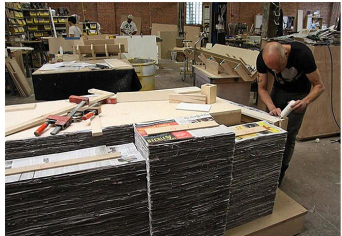
Fig.22. Proceso de montaje. Ensamblaje de la madera y los periódicos.
