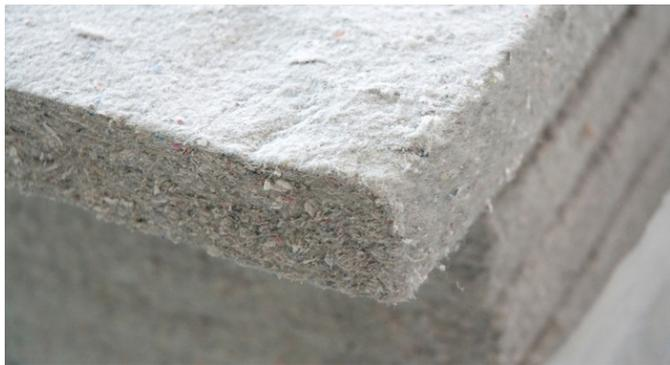
Fig.25. Aislante de celulosa.
