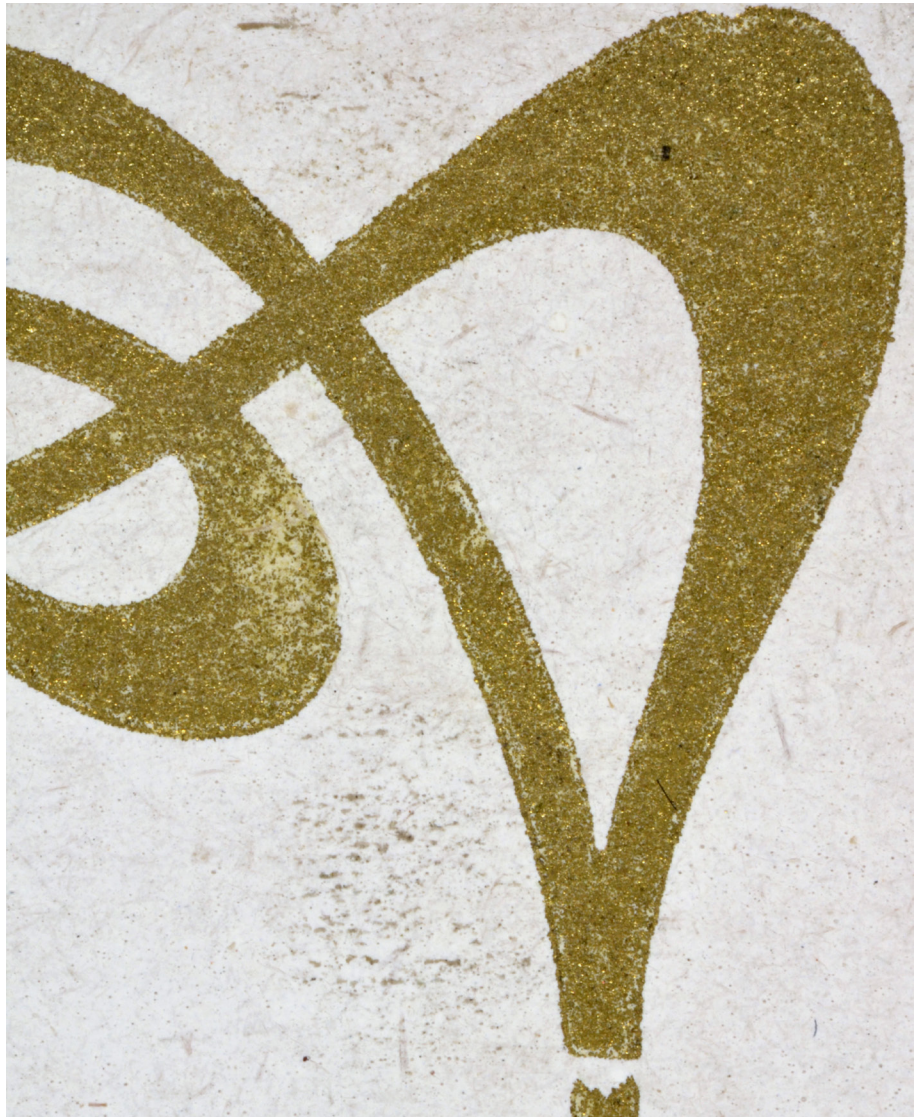
Figura 28. Detalle macroscópico del desgaste puntual en las tintas serigráficas.
