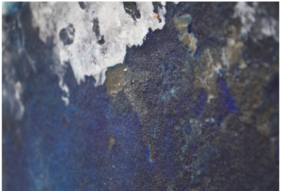
Fig. 12: Detalle de la superficie donde la cera va adherida a la espuma de polietileno.
