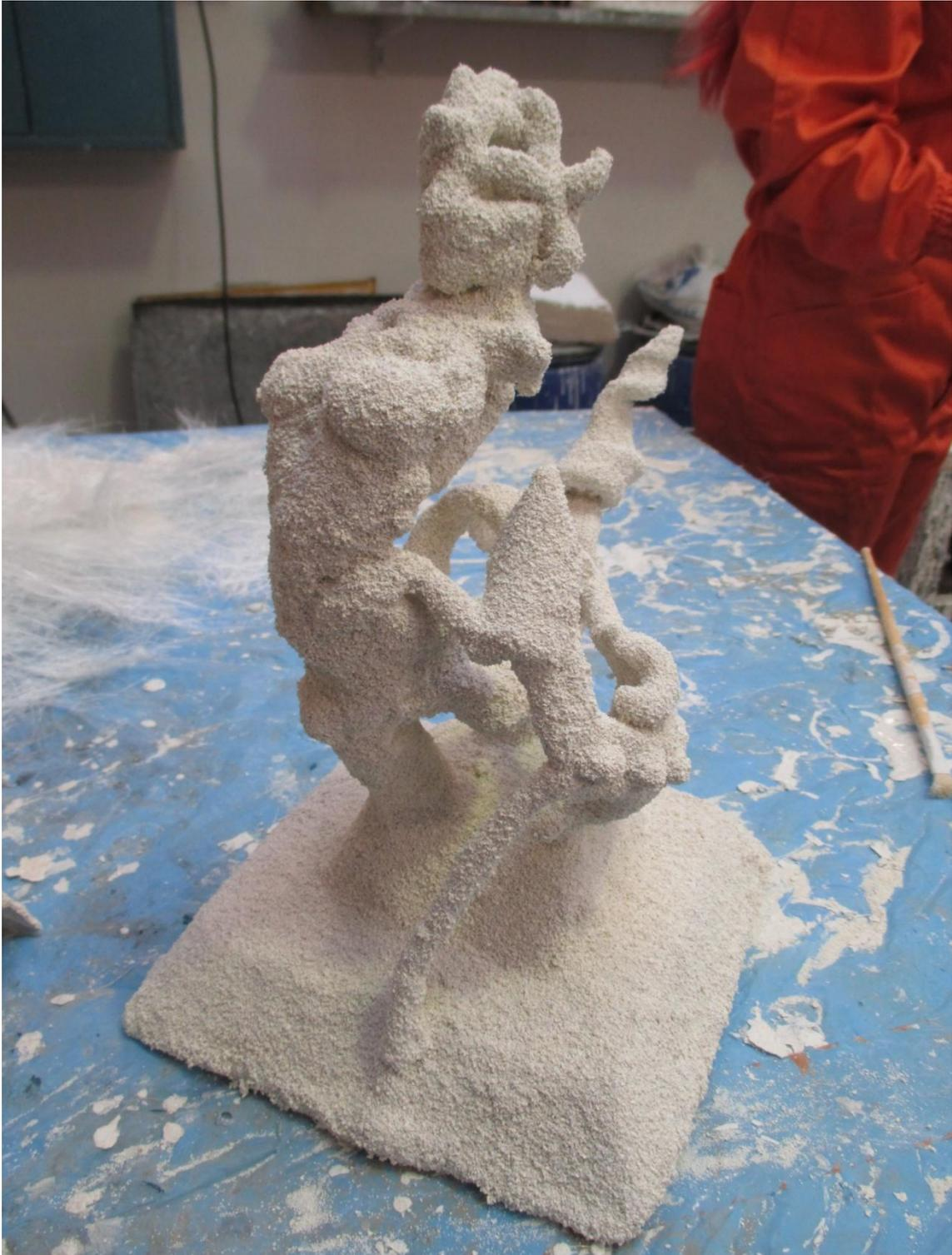
Con todas las capas necesarias para la posterior fundición en Latón.
