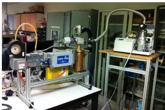
Figura 3.5. Equipo de microondas con cavidad circular y bomba de alto vacío.
