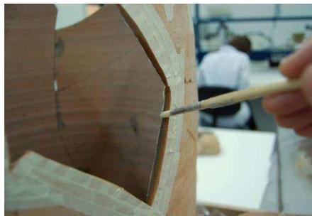
Fig. 16. Aplicación de capa intermedia, Acril 33 al 10%, mediante pincel
