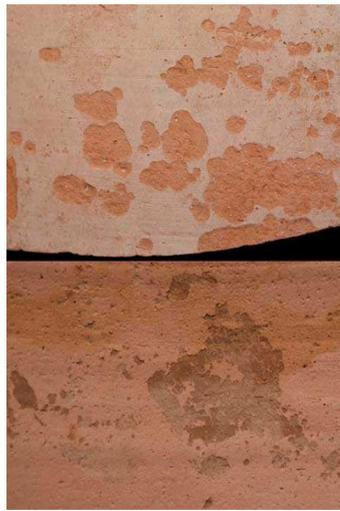
Fig. 4. Descamación en la parte interna y pérdida de engobe en la parte externa.
