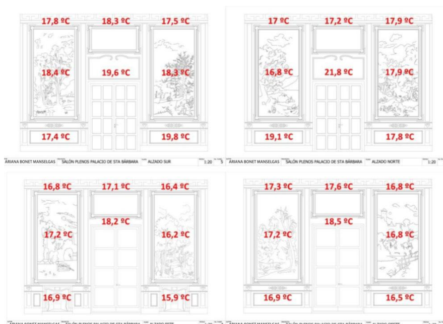
Figura 29. Gráfico de la temperatura superficial de las pinturas.
