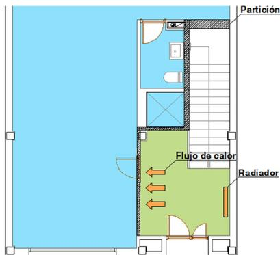
*Imagen 36. Partición vertical en contacto con no habitable*
