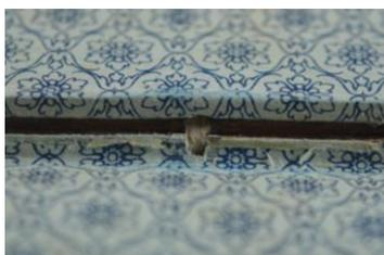
FIGURA 17. Zona de unión de las cubiertas fragmentada.
