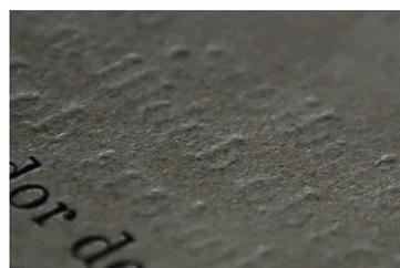
FIGURA 10. Relieve causado por la presión realizada con las planchas tipográficas.
