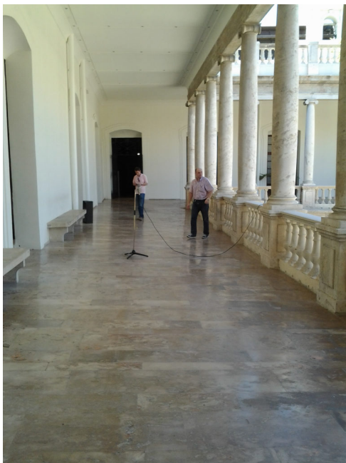
Imagen 32 Fotografía del equipo de medición con la fuente, el receptor, el portátil y el amplificador.
