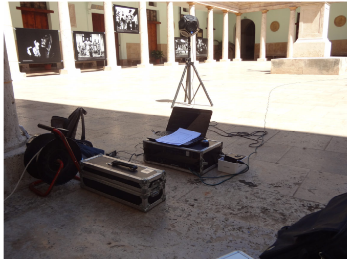
Imagen 32 Fotografía del equipo de medición con la fuente, el receptor, el portátil y el amplificador.
