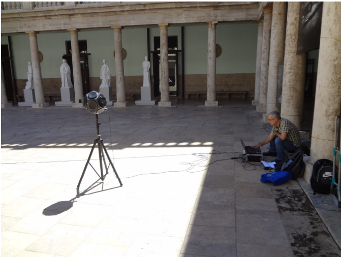
Imagen 32 Fotografía del equipo de medición con la fuente, el receptor, el portátil y el amplificador.
