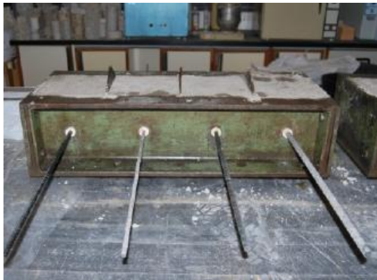
Figura 41: Preparación de las probetas de pull-out 58
