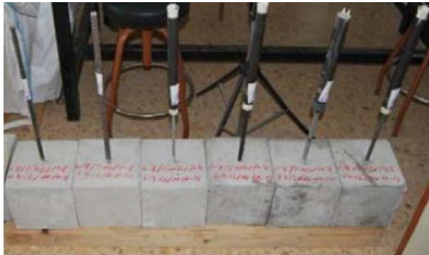
Figura 42: Preparación de los anclajes de las probetas para el ensayo de pull-out
