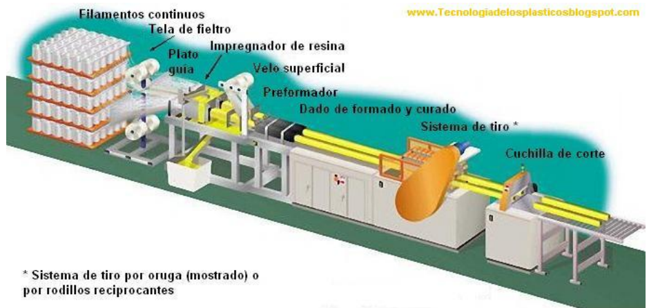
Figura 18: Proceso de fabricación de barras de BFRP
