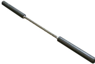
Figura 31: Pestañas de sujeción de los extremos de la barra
