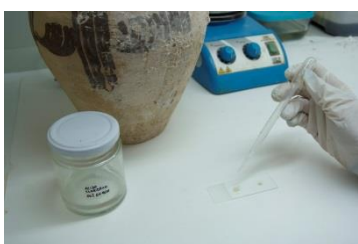
Pressa de mostres d'una concreció i realització de la prova de contenció de carbonats amb àcid clorhídric.
