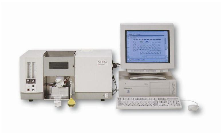
*Figura 14: Espectrofotómetro de absorción*
