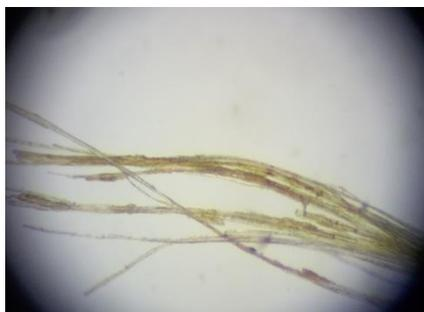
Ilustración 17: Imagen al microscopio de las fibras de lino
