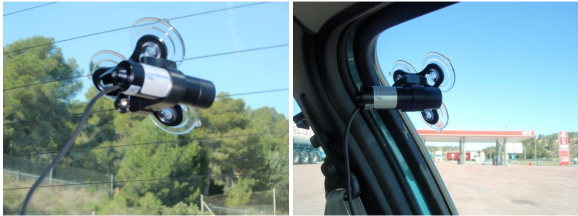
Figura 7-6. Cámaras de video del sistema VBOX en el turismo instrumentalizado
