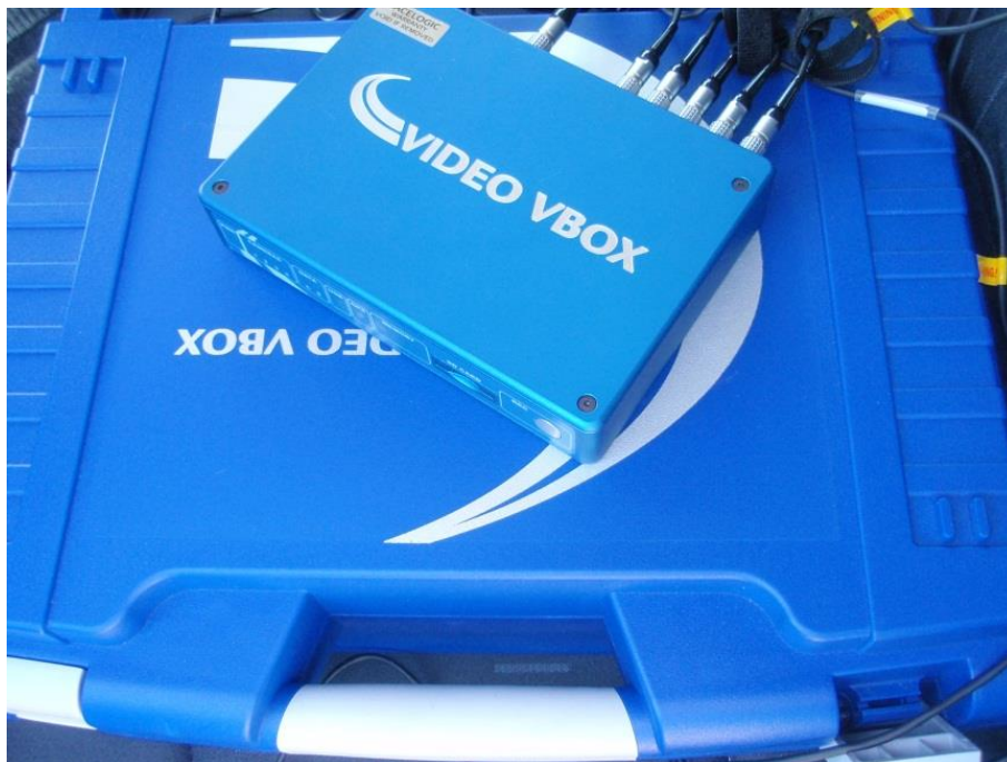
Figura 7-10. Unidad de grabación del sistema VBOX
