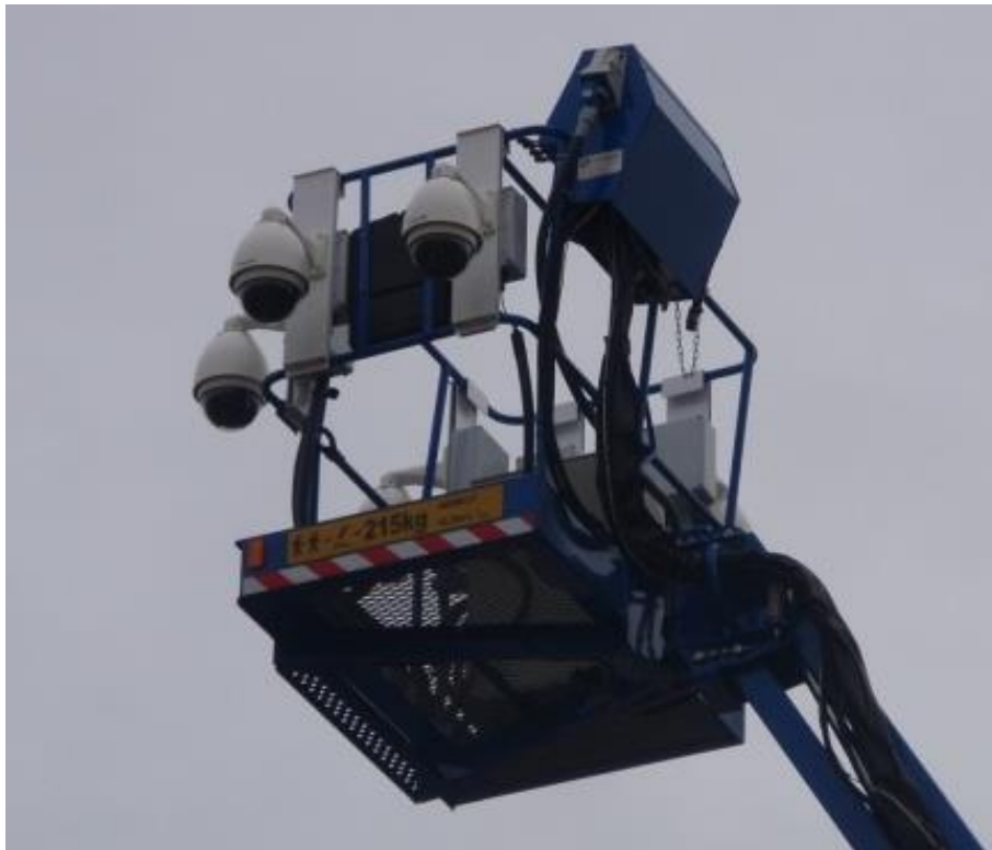
Figura 7-3. Cámaras de video instaladas en la cesta del laboratorio móvil de tráfico
