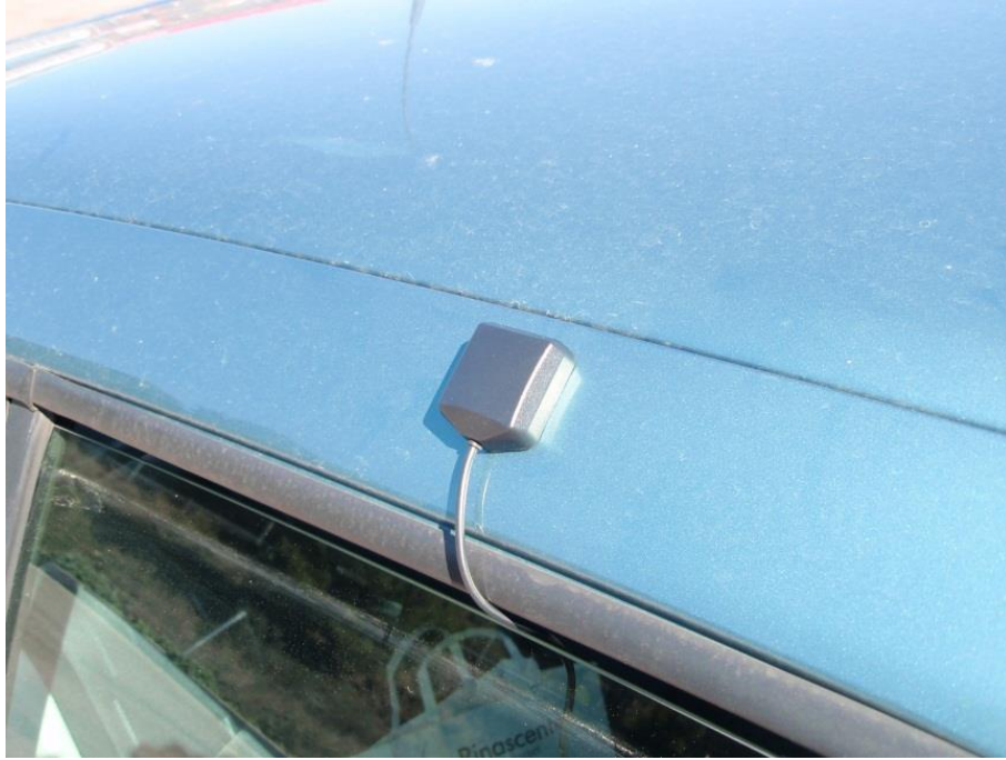
Figura 7-8. Antena del receptor GPS del sistema VBOX, instalada en el techo del vehículo
