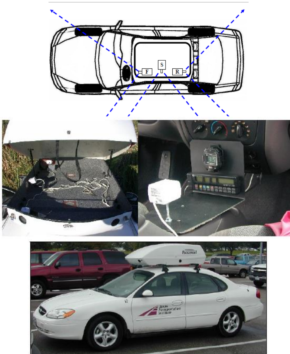
Figura 3-2. Esquema y fotografías del vehículo flotante empleado por Carlson et al. (2006)
