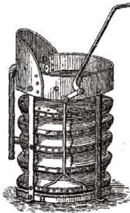
Fig. 7.51 Fragua portátil a una corriente (Rovina)
