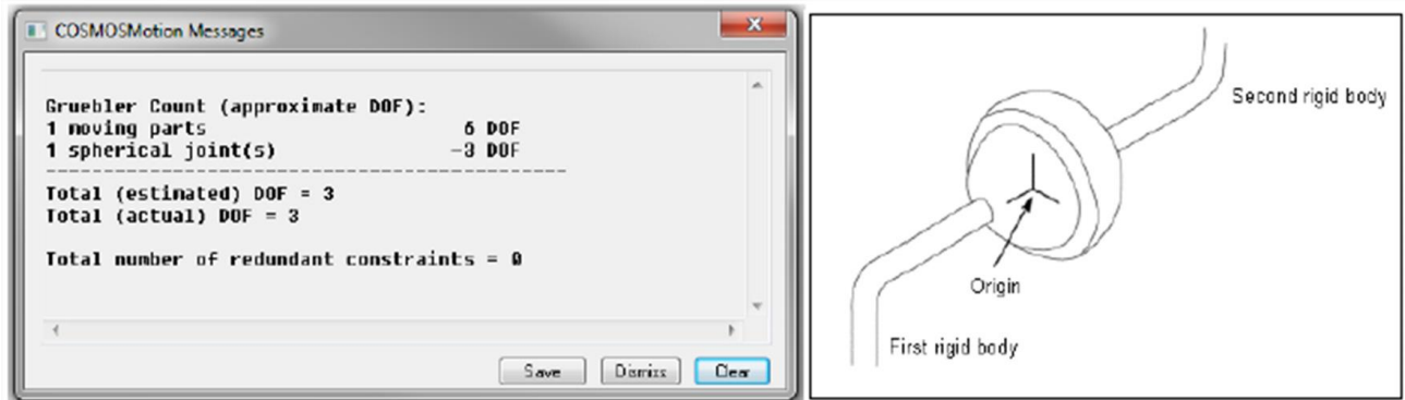
Figura 44. Análisis de la movilidad del par esférico y esquema del mismo
