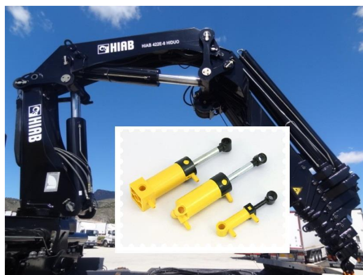
Figura 5. Cilindro hidráulico LEGO Technic y real
