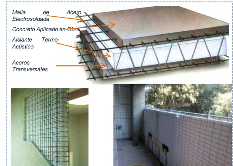
Imagen de Sistema constructivo 3D Panel.
