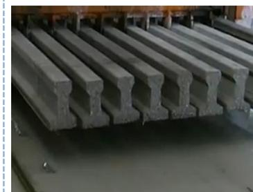
Imagen de Vigueta Pretensada
