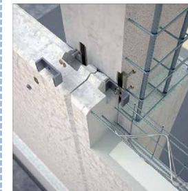
Unión a paneles mediante atornillado,
