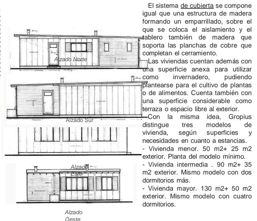
El sistema de cubierta se compone igual que una estructura de madera formando un emparrillado, sobre el que se coloca el aislamiento y el tablero también de madera que soporta las planchas de cobre que completan el cerramiento.
