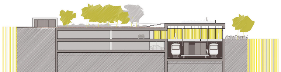
Imagen 140. Sección Estación Alboraya-Palmaret. Rstudio/Wikiarquitectura.
