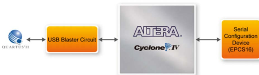
Figura 32 Programación de un dispositivo de configuración de serie con una “serial flash loader”
