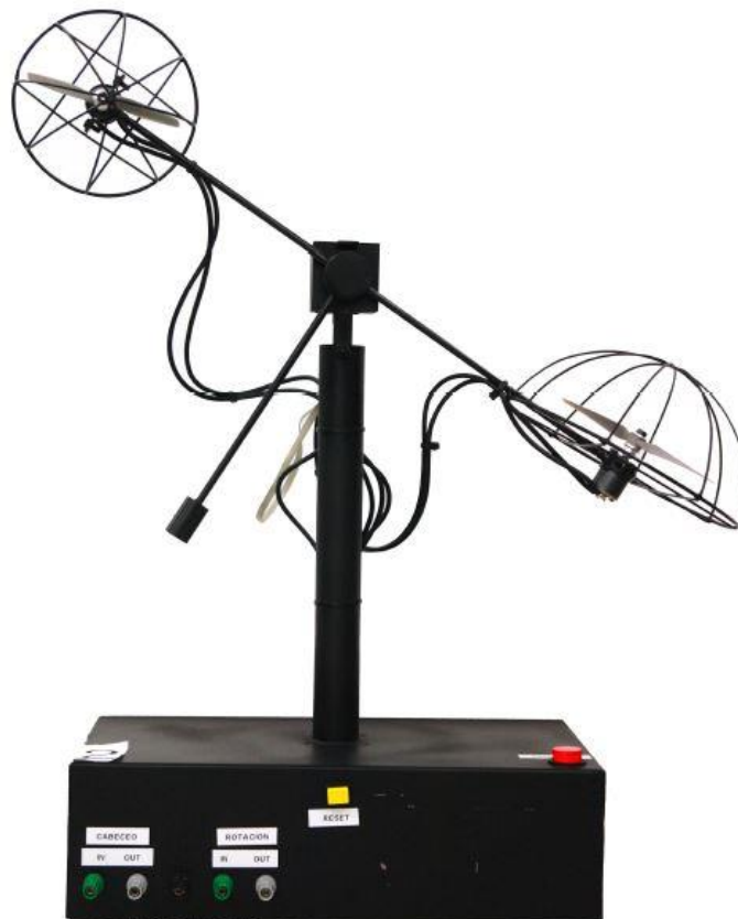
Figura 1 Maqueta de un simulador de cabeceo y rotación de un helicóptero
