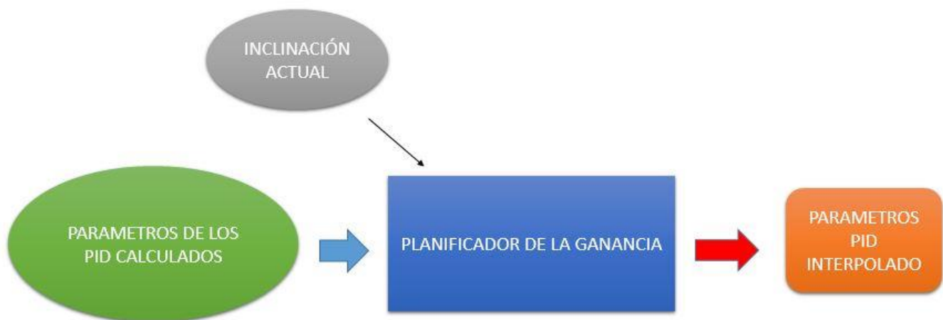
Figura 26 Diagrama de bloques del interpolador de los parámetros del PID.
