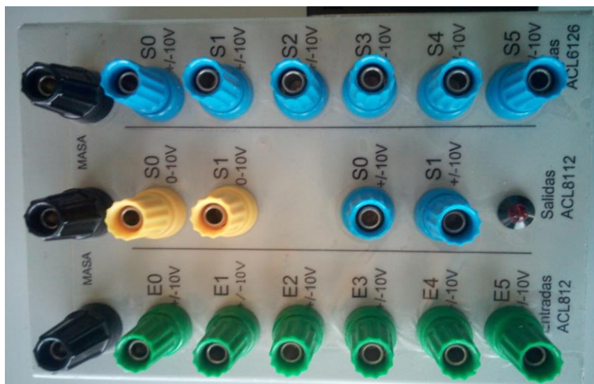
Figura 9 Bornera de conexiones de la tarjeta de adquisición de datos.
