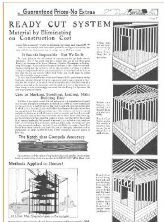
Fig. 13. Proceso constructivo del catálogo de viviendas de Gordon-Van Tine.
