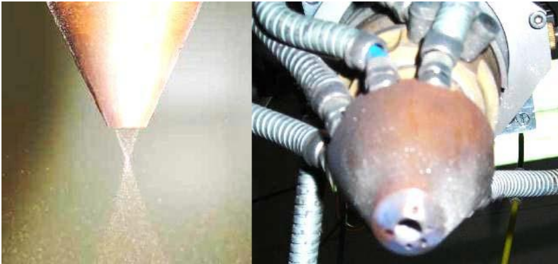
Fig. 28. Boquillas coaxiales comerciales: cortina de polvo (izquierda) y de 3 orificios (derecha). (Steen 2003)
