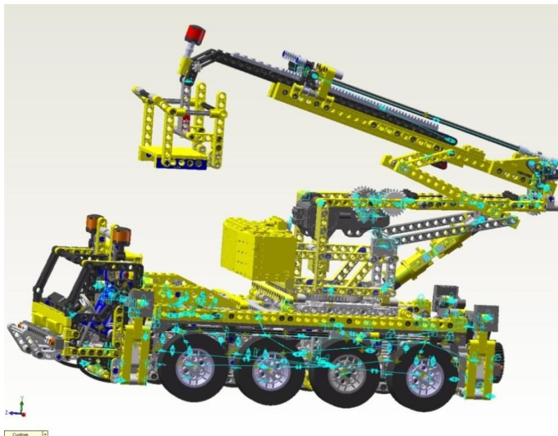
Ilustración 183. Modelo cinemático auto-alineador del prototipo LEGO Technic 8421-1 + 8421-3
