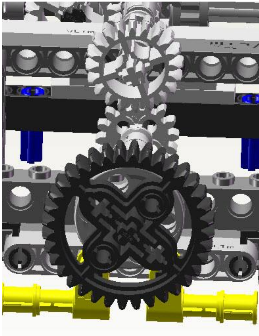
Ilustración 185. Control de la dirección (rueda negra) y del sistema de anclaje (rueda gris).
