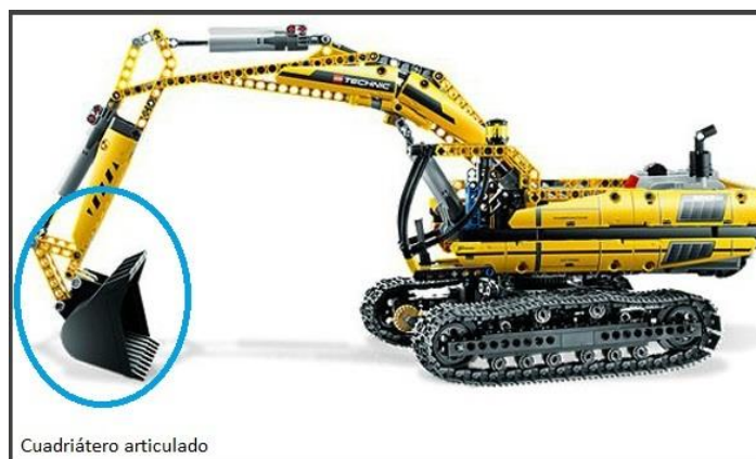
Ilustración 4. Cuadrilátero articulado en modelo LEGO TECHNIC.
