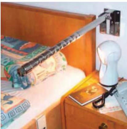
Fig. 5.77. Ha de asegurarse una adecuada luz de lectura junto al cabecero de la cama.
