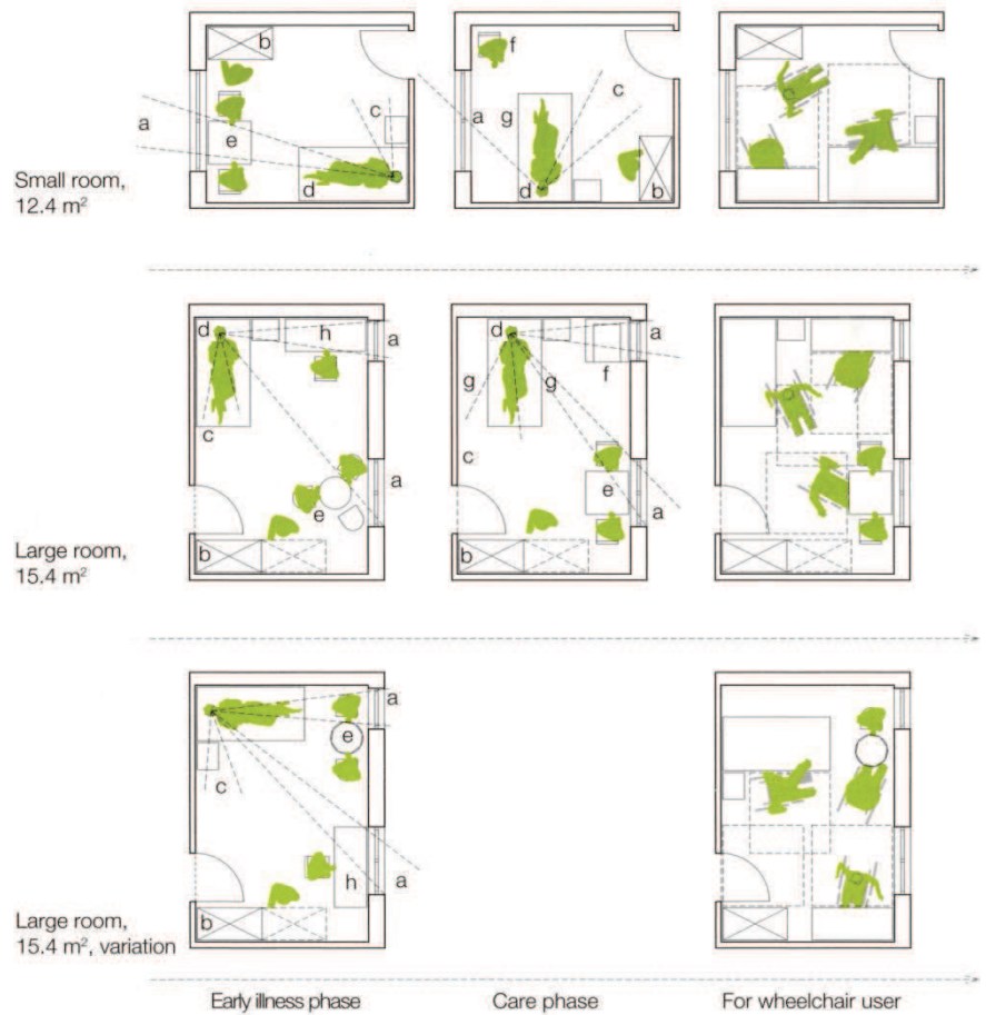
Fig. 5.78. Distintos diseños de habitación para personas con demencia: a) vista al exterior; b) almacenamiento; c) vista general de la habitación; d) cama; e) espacio de relación; f) asiento; g) higiene personal; h) escritorio.
