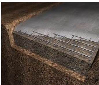
Figura 6.25. Capa de hormigón armado (solera)
