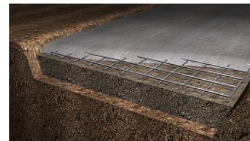
Figura 4. Solera de hormigón
