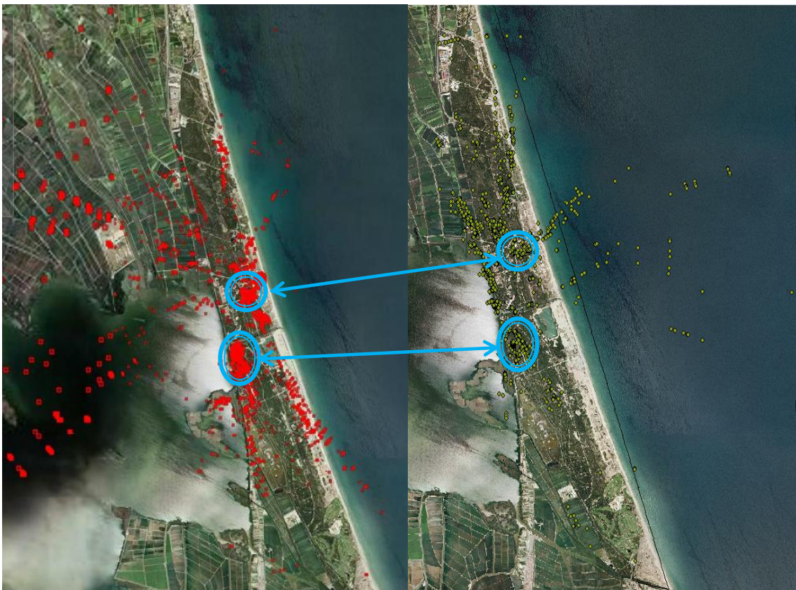
Figura 95: Comparación de las alarmas no reales generadas por ambos sistemas, a la izquierda las generadas por el antiguo sistema, a la derecha las generadas por el nuevo sistema
