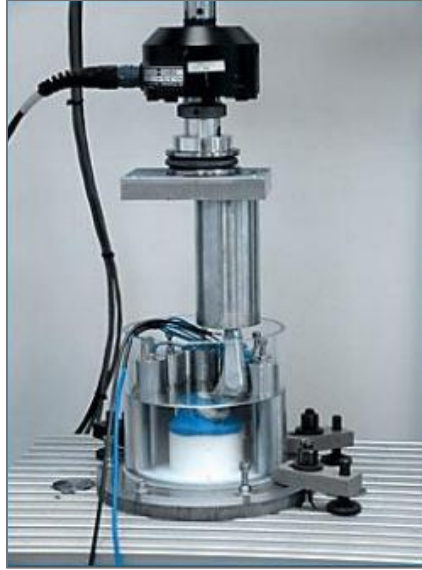
Figura 15: Test de corrosión de la cabeza femoral. (ENDOLAB)
