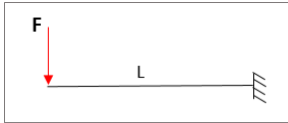
Figura 7: Diagrama de fuerzas. Bulón Unión Disco-Seguidor.
