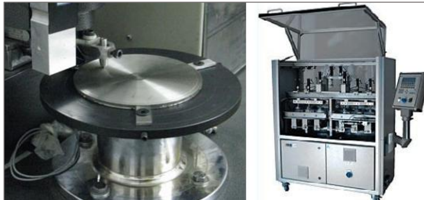
Figura 14: Izquierda: tribómetro Pin-On-Disk. Derecha: Simulador de cadera de acuerdo con la ISO 14242. (ENDOLAB)
