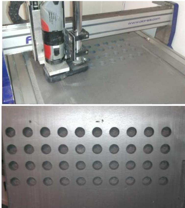
**Figura 5.8: Mecanizado de la espuma de alta densidad (arriba). Matriz de probetas terminada (abajo).**
