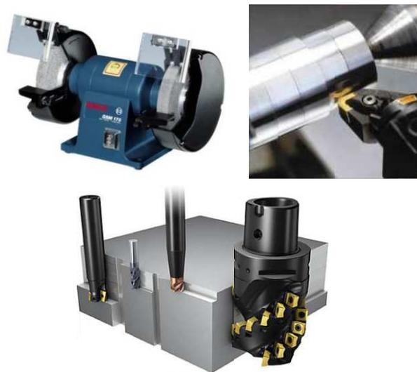
**Figura 1.1: Esmeriladora (Ferrovicmar, 2014) (izquierda), Proceso de Torneado (Fabrimetal, 2014) (centro), Fresado en Escuadra (Numaingenieria, 2014) (derecha).**
