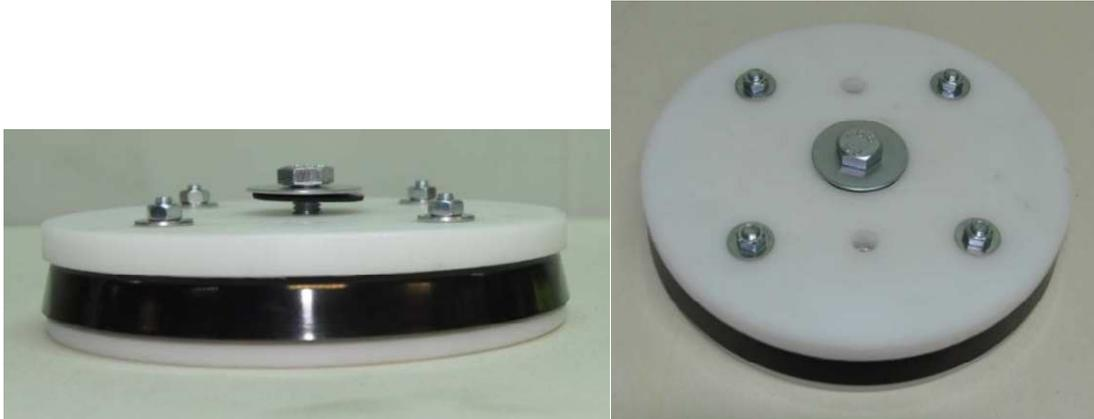
**Figura 4.29: Pistón con la válvula abierta (Izquierda), pistón completamente montado (Derecha).**
