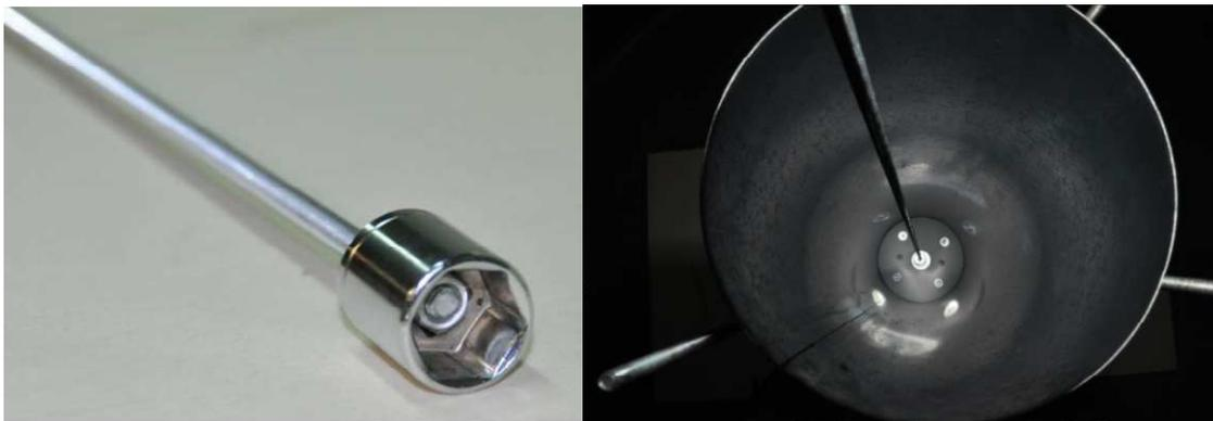
**Figura 4.30: Herramienta de apertura y cierre de la válvula del pistón (Izquierda), aplicada en el pistón (Derecha).**
