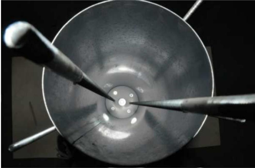
**Figura 4.31: Pistón con las varillas roscadas M10.**
