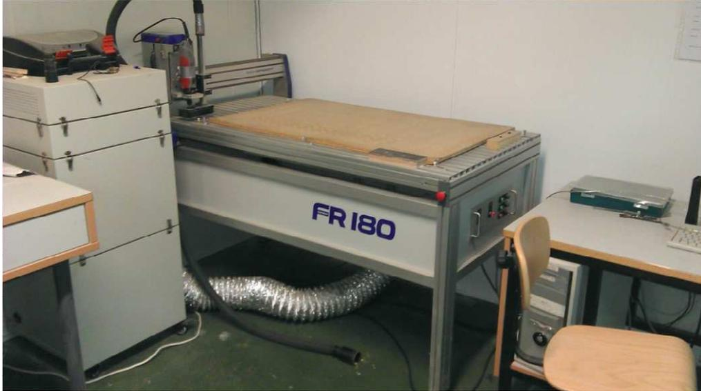
**Figura 5.2: Fresadora CNC**
