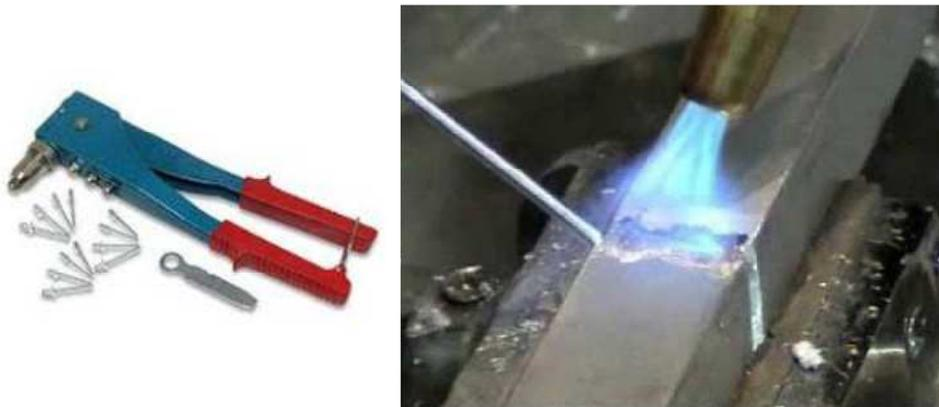
**Figura 1.3: Remachadora manual (TR, 2014) (izquierda), Soldadura TIG en aluminio (Saca, 2014) (derecha).**
