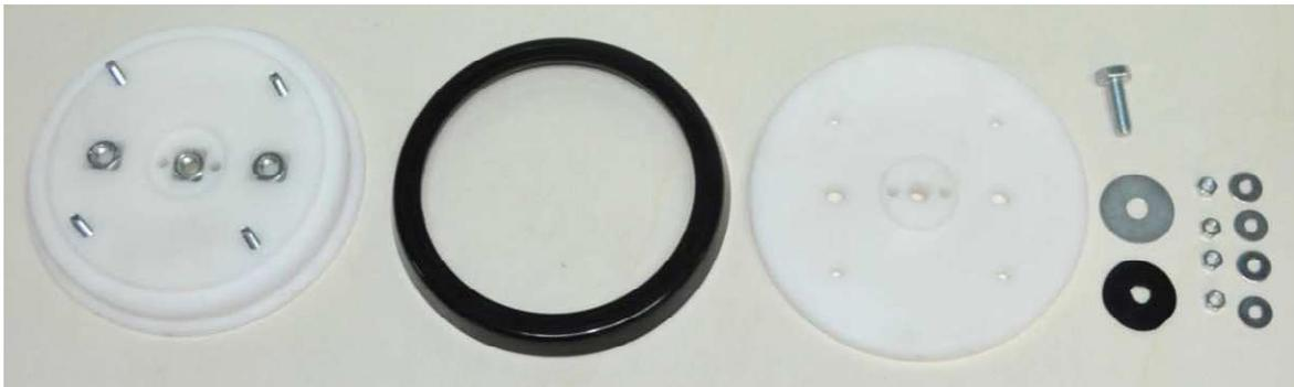
**Figura 4.28: Partes del pistón.**
