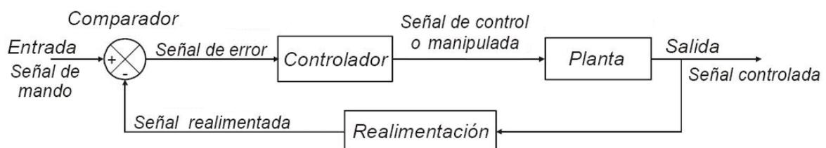
**Ilustración 12 - -Diagrama de un Sistema**
