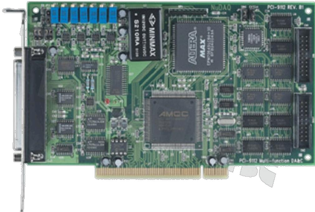
**Ilustración 7 - Tarjeta de Adquisición de Datos**
