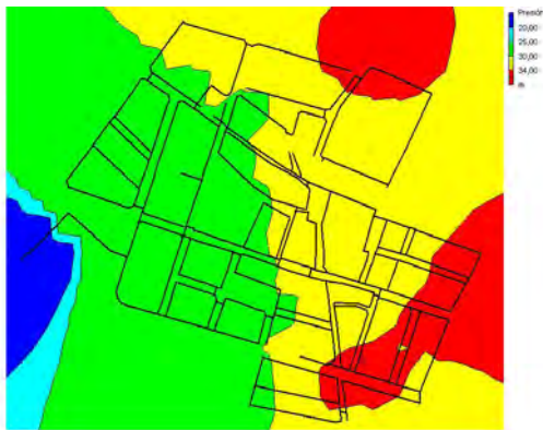
Mapa de isótopas de presión en hora punta el día de máximo consumo 20:00 horas.
