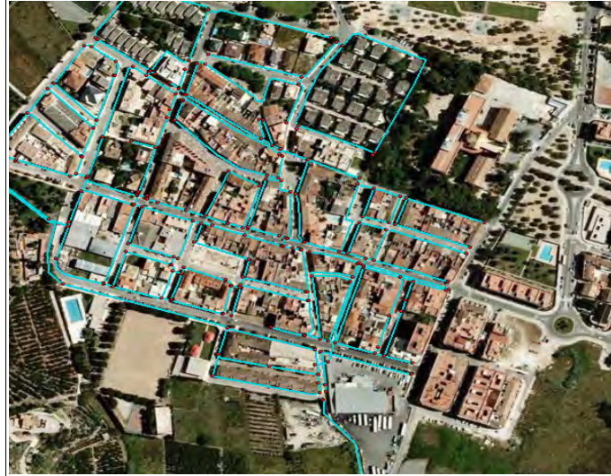
Vista general de la red de agua potable de Benirredrá.
