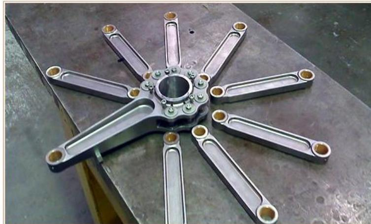
**Figura 3.1.1:** Forma de las bielas secundarias (pequeñas) y la biela principal en un motor radial de 9 cilindros
