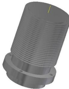
*Figura 3.1.10: Cilindro aleteado para un motor radial*
