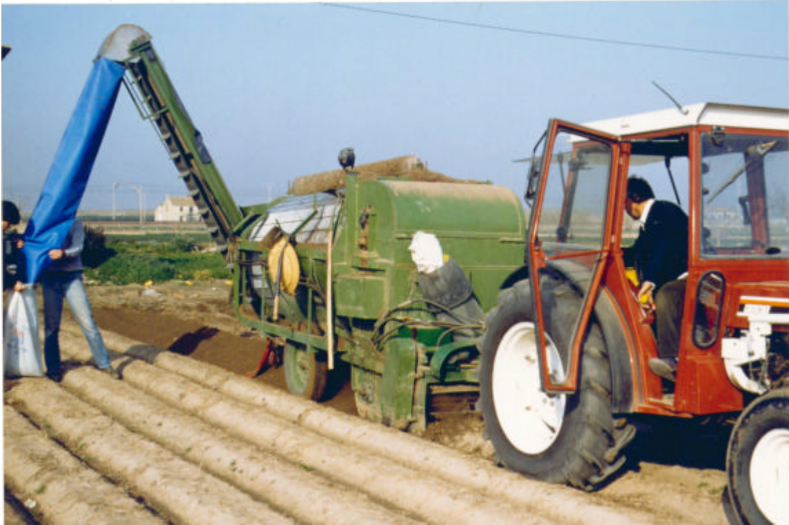
Figura 11. Recolección mecanizada de los tubérculos de C. esculentus L. Campo experimental en Alboraiá (Valencia)
