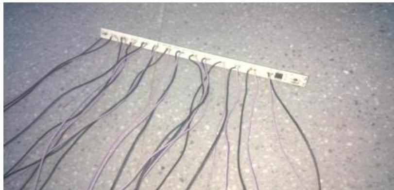
Fig. 31 Detalle de los cables soldados a la placa, en el lugar donde antes estaban los leds (realización pieza del boceto Fig. 29)
