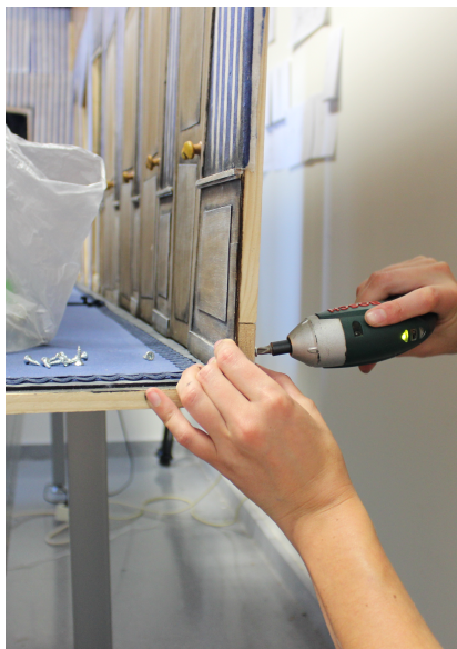
Atornillant l'estructura del passadís. Material: esquadres i vis. Juny 2014.
